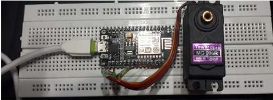
Figura 3.26: Conexión NodeMCU con Servomotor y cable de conexión.
