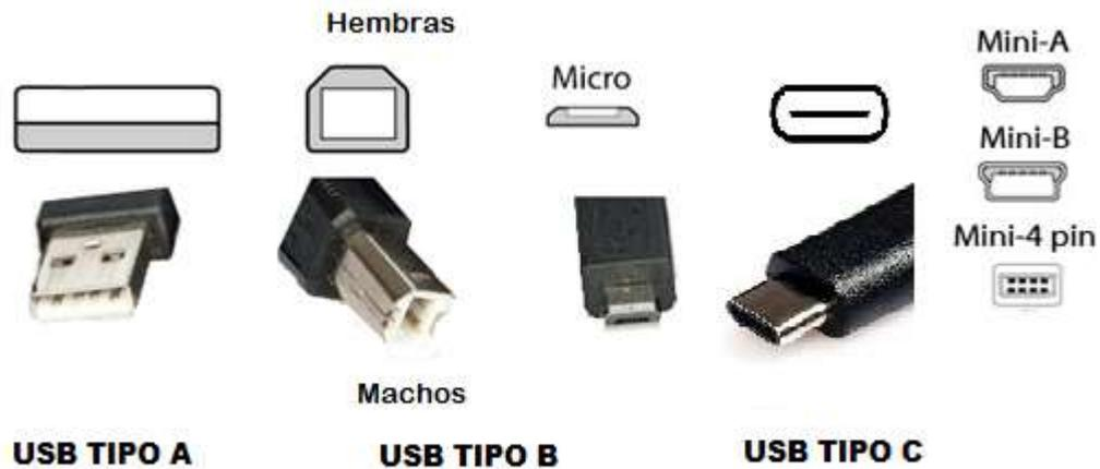
Figura 2.11: Tipos de conectores USB, terminales tanto macho, hembra y especiales.
