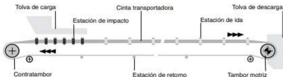
Figura 2.5: Estructura básica de una cinta transportadora.
