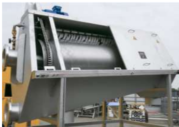
Figura 2. 2 Reja de Tambor Rotatoria NTF Nijhuis (Extracción de partículas gruesas)
