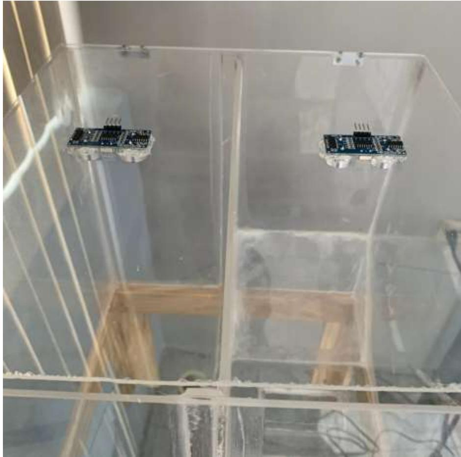
Figura 3.6 Sensores ultrasónicos en el dosificador
