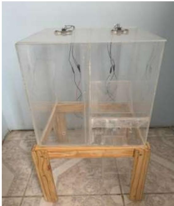
Figura 3.20 Reservorios de agua y comida con sus respectivos sensores
