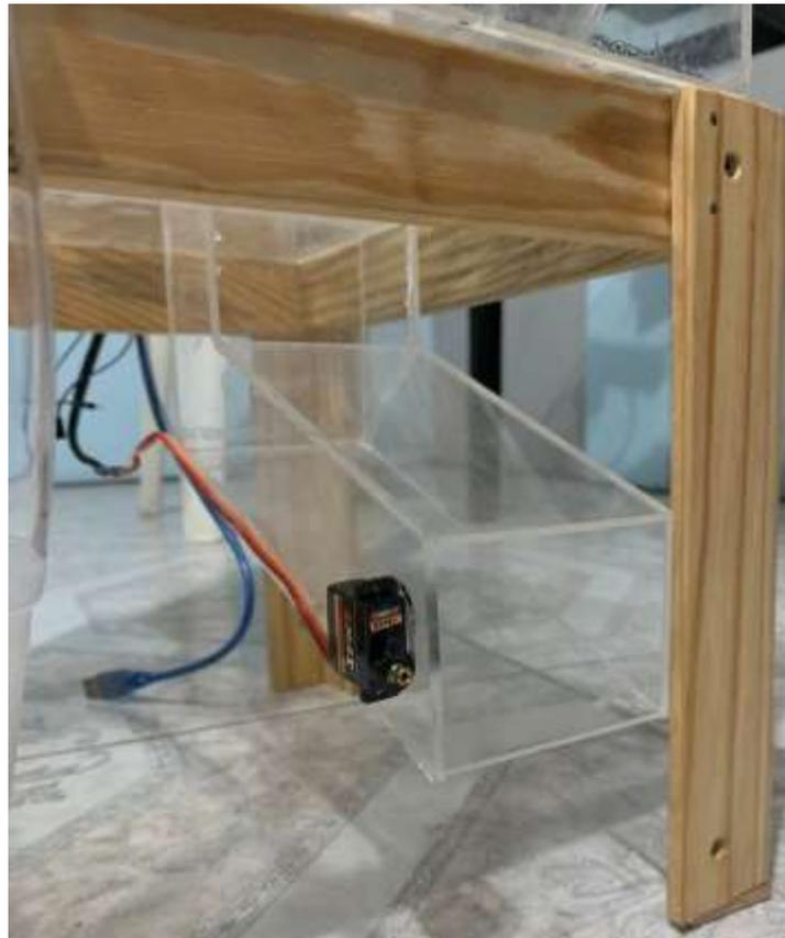
Figura 3.33 Servo motor instalado
