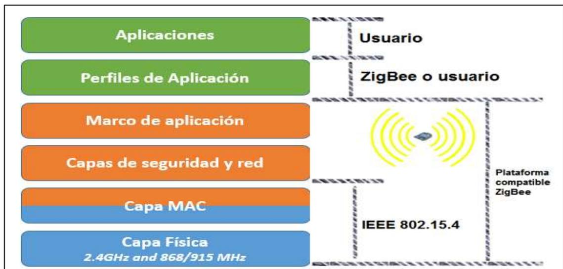
Figura 2.4 Capas del protocolo Zigbee/802.15.04
