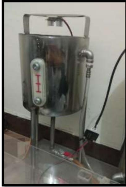
Ilustración 3.4. Tanque de Proceso con el indicador de nivel
