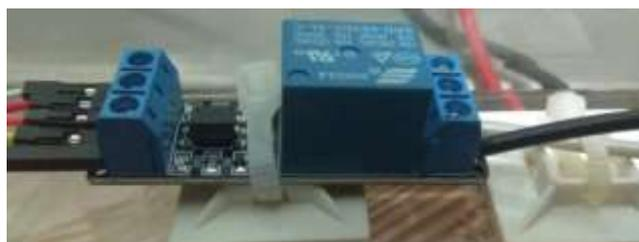
Ilustración 2.33. Módulo Relay 1CH 5VDC
