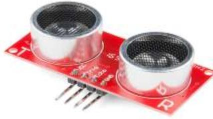
Ilustración 2.35. Sensor ultrasónico HC-SR04
