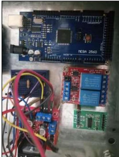
Figura 3. 35: Interior del tablero de control
