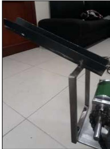
Figura 3. 25: Rampa dosificadora de tapas
