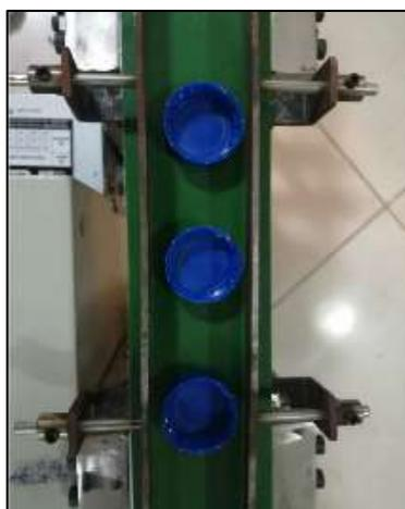
Figura 3. 38: Calibración de guías
