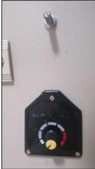
Figura 3. 33: Control de velocidad y temperatura
