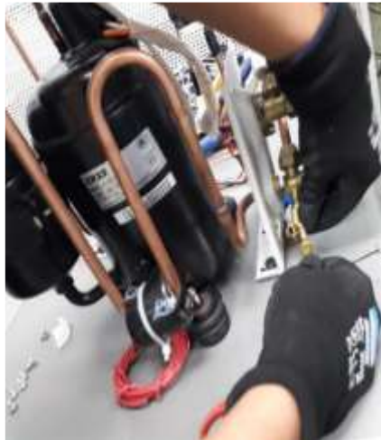
Figura 36 Conexión de la manguera a la válvula de servicio Fuente: Harold Gherardy
