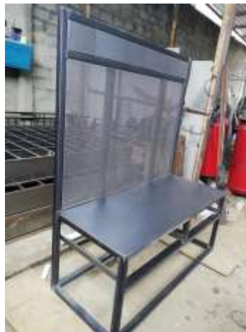
Figura 20 Estructura libre de exceso de soldadura Fuente: Harold Gherardy
