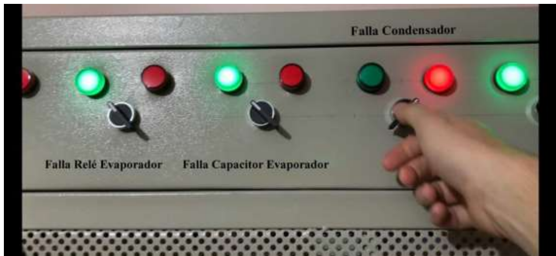
Figura 45 Activación de falla del Condensador
