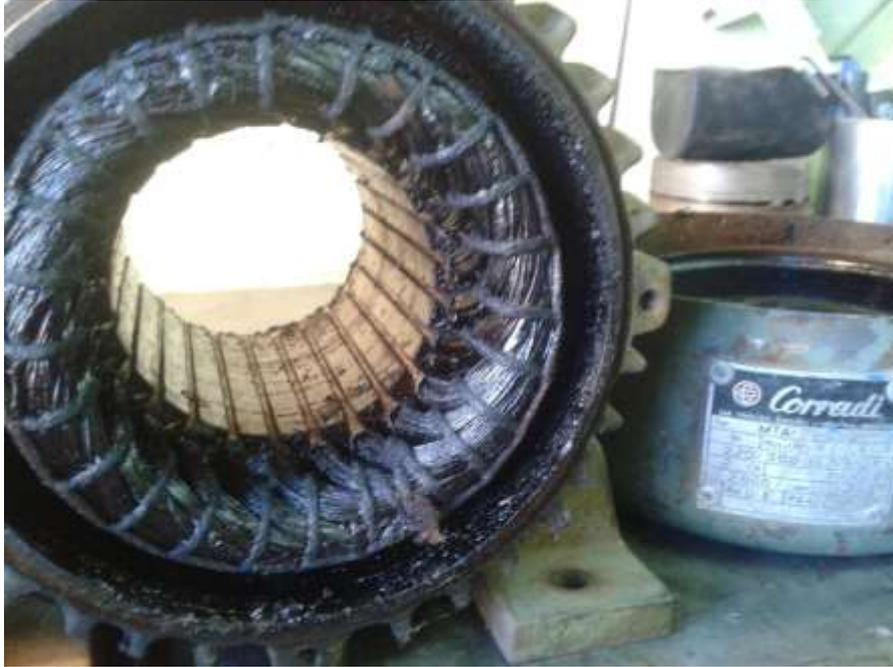
*Figura 2. 8: Bobina de motor quemada*
