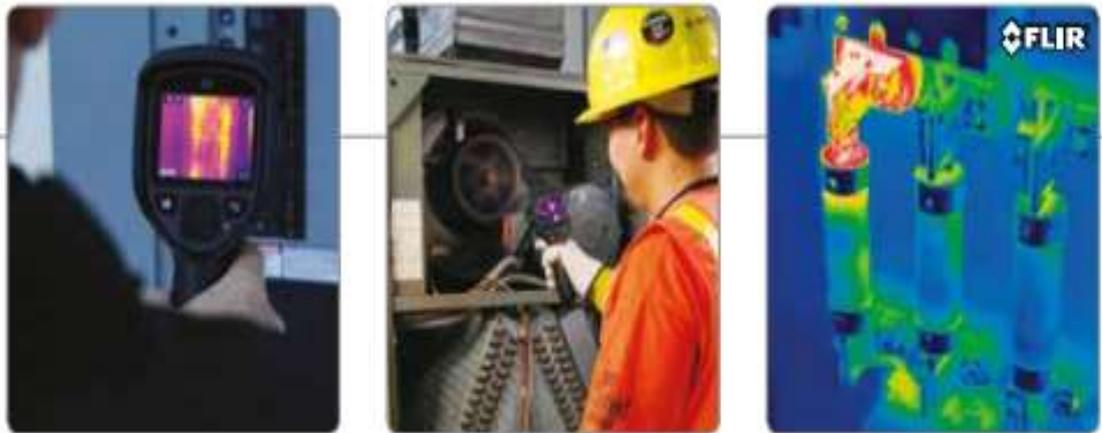
Figura 2. 13: Técnica de termografía
