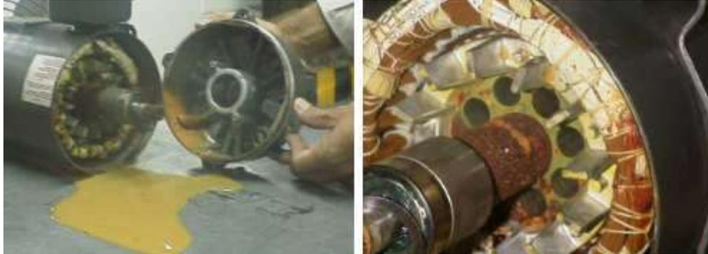
Figura 2. 10: Motor con humedad
