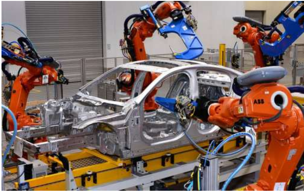
Figura 2.4. Sistema autónomo en la producción de automóviles. Fuente: (Pérez-López, 2015)
