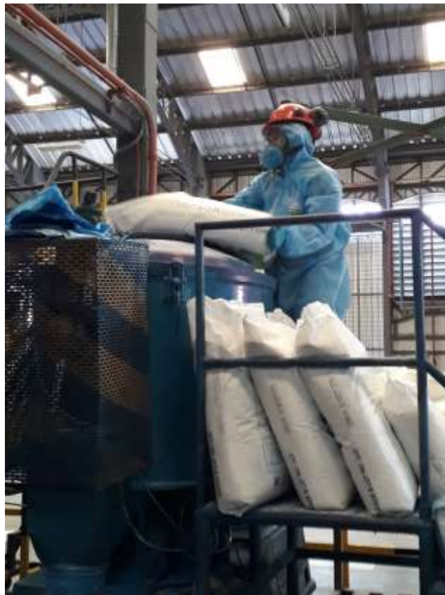
Figura 3.6: Llenado de la Mezcladora. Fuente: Elaborado por el autor.
