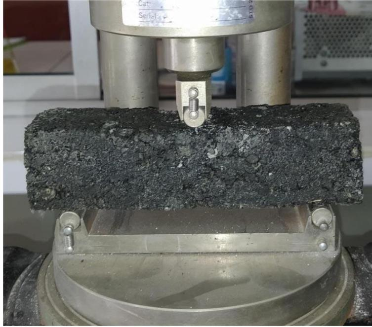
**Figura 40.** - Ensayo de Módulo de Rotura.
