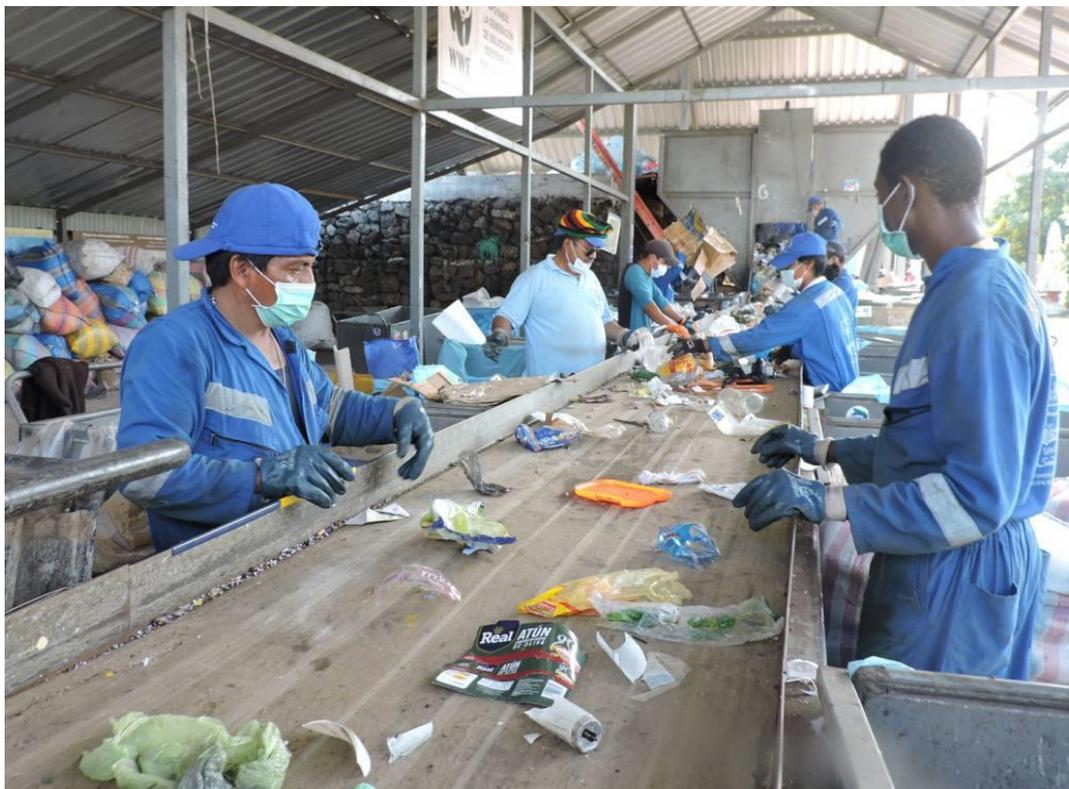
**Figura 28.** - Clasificación del plástico realizada en la planta de residuos sólidos de la isla Santa Cruz
