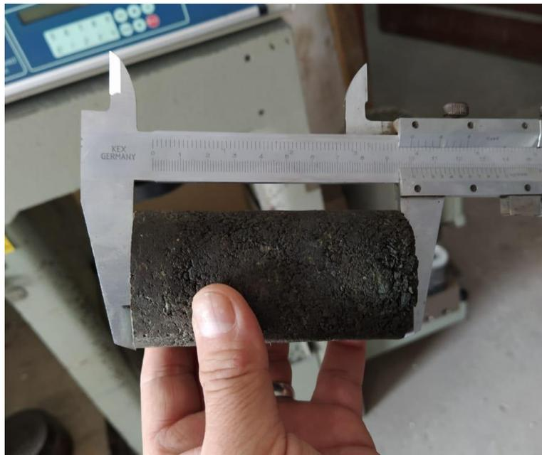
**Figura 35.** - Medición de longitud de la probeta.
