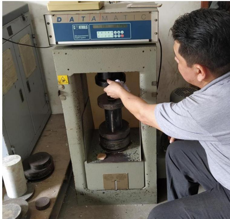
**Figura 37.** - Ensayo de Resistencia a la Compresión Simple.
