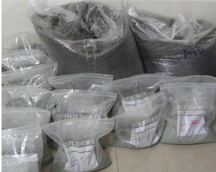
**Figura 33.** - Separación y etiquetado del material tamizado
