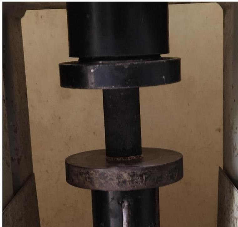
**Figura 38.** - Ensayo de Resistencia a la Compresión Simple.
