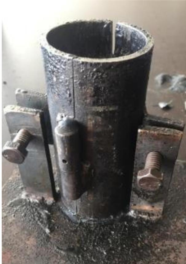
**Figura 31.** - Molde fabricado para la elaboración de probetas.
