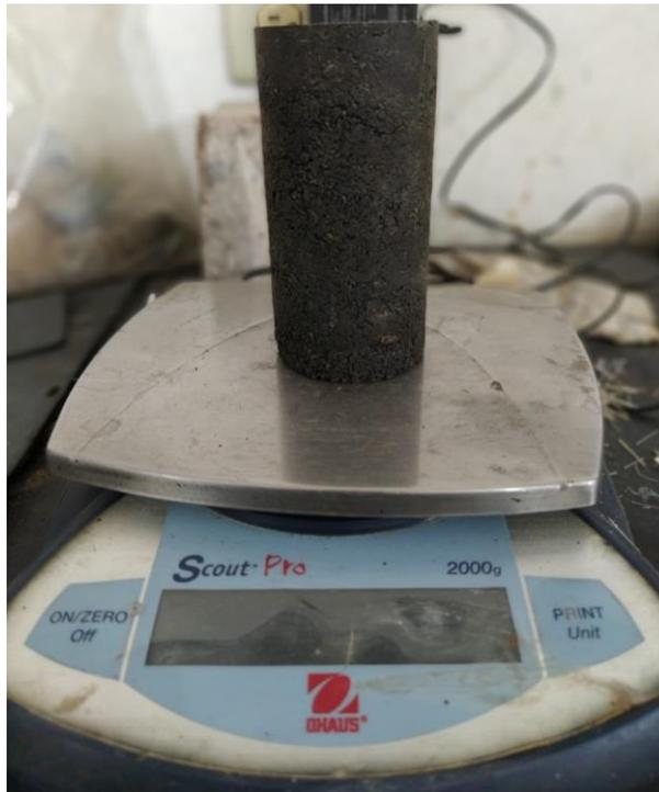
**Figura 36.** - Toma del peso de la probeta.
