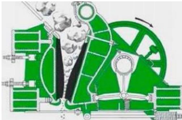
**Figura 10.** - Trituradora de mandíbulas de doble efecto o "Blake"
