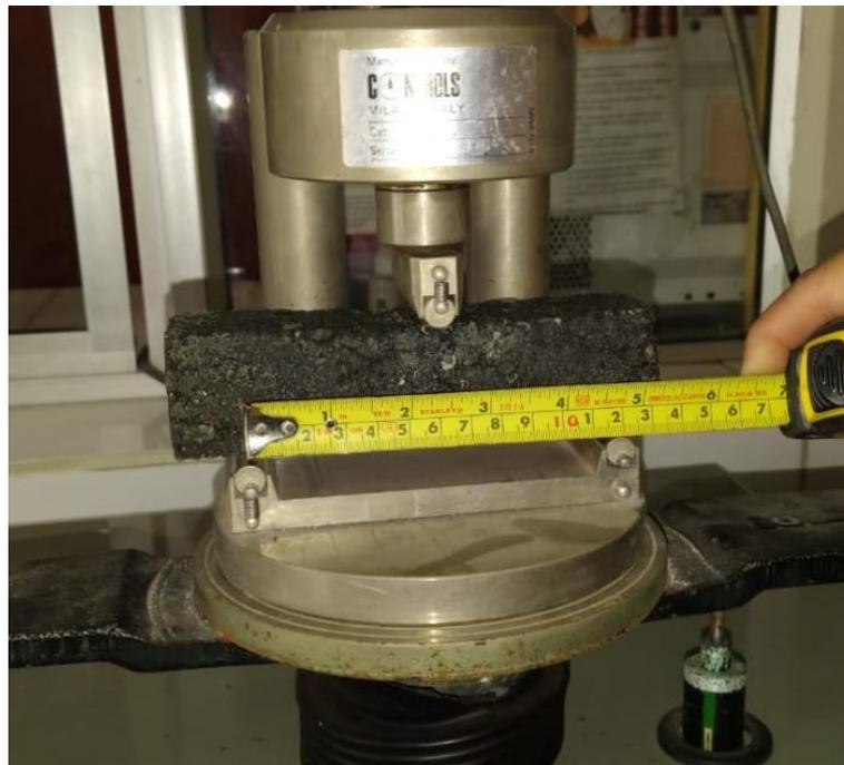
**Figura 39.** - Ensayo de Módulo de Rotura. Comprobación de la distancia entre los apoyos.
