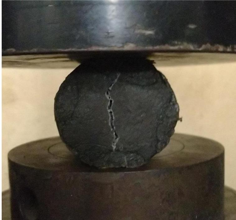
**Figura 42.** - Forma de la falla de la probeta en el ensayo de Tracción Indirecta.
