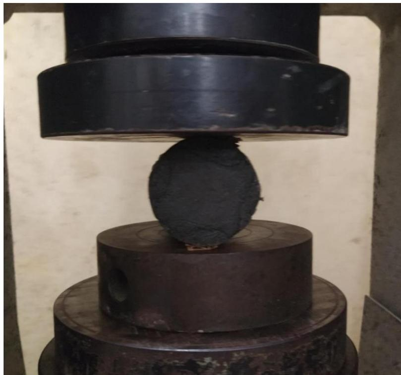
**Figura 41.** - Ensayo de Tracción Indirecta.
