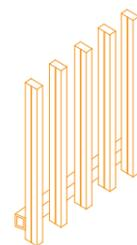
Paneles de colores de material aluzinc, con sección de 0.20 x 0.09 m de Hunter douglas con estructura tubular cuadrada de volado de metal con recubrimiento pintura anticorrosiva
