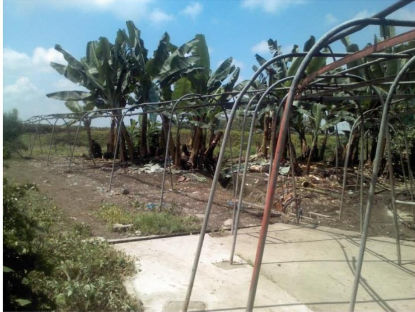
Fuente: Observación directa del proceso de producción. En la imagen se observa el sistema que sirve para transportar los racimos de banano denominado cable vía.
