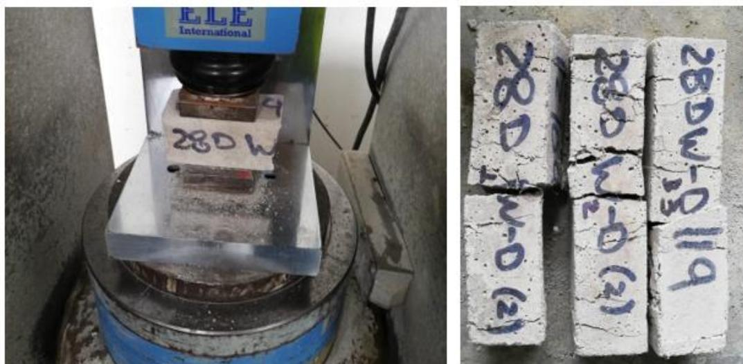
Ilustración 41 Procedimiento de ensayo a compresión
