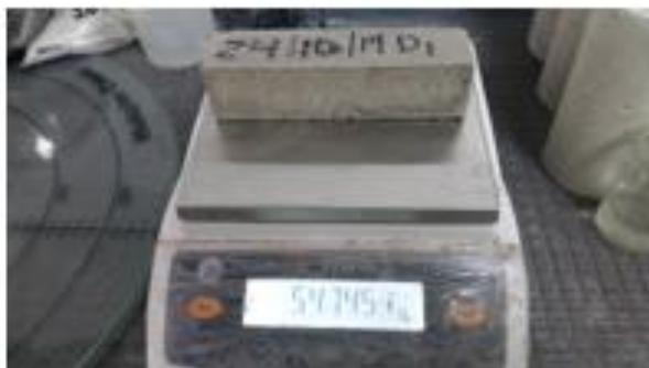
Ilustración 34 Determinación de la masa seca
