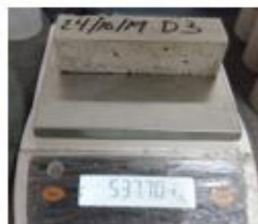
Ilustración 35 Determinación de la masa saturada
