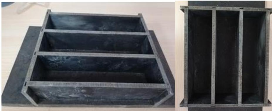
Ilustración 14 Moldes para ensayo de flexotracción
