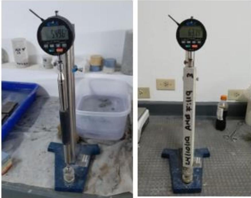
Ilustración 42 Procedimiento de lecturas para cambio de longitud
