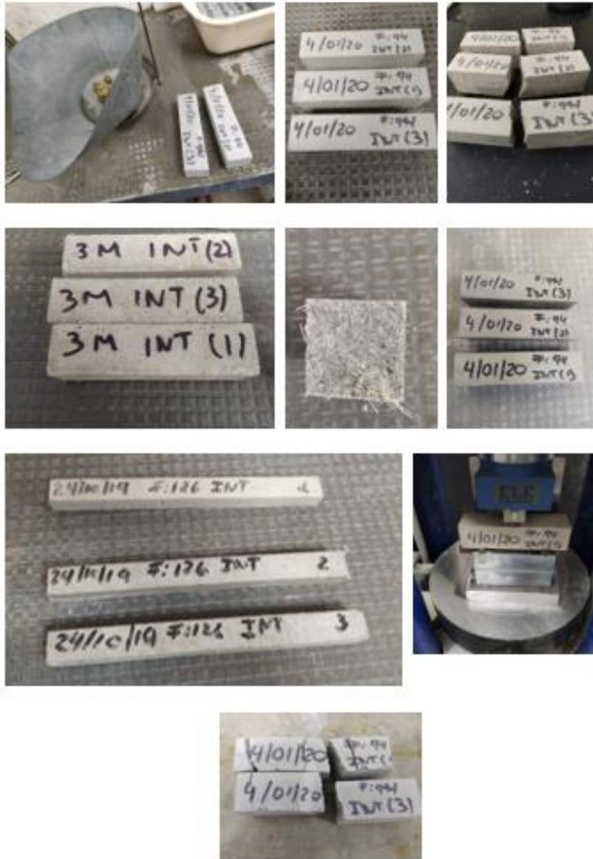
Ilustración 51 Serie de ensayos para envejecimiento ambiente intemperie
