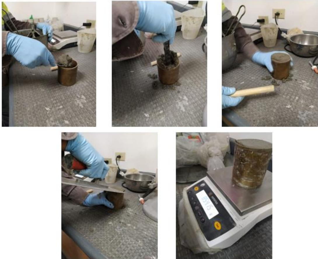
Ilustración 31 Procedimiento de ensayo densidad en estado fresco del mortero
