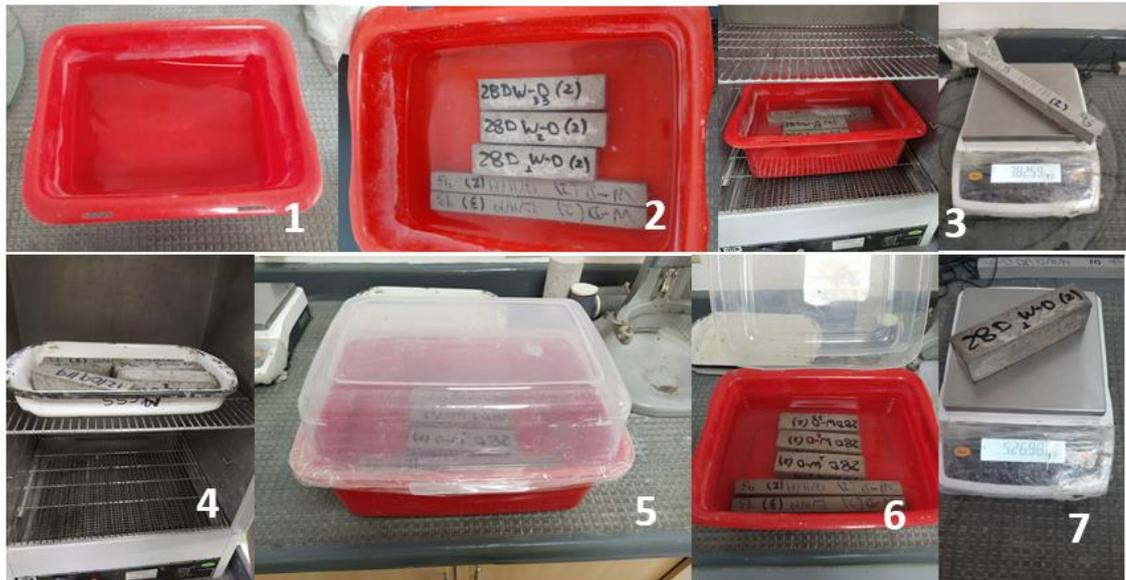
Ilustración 17 Proceso de envejecimiento Wet and Dry según (Wei et al., 2016).
