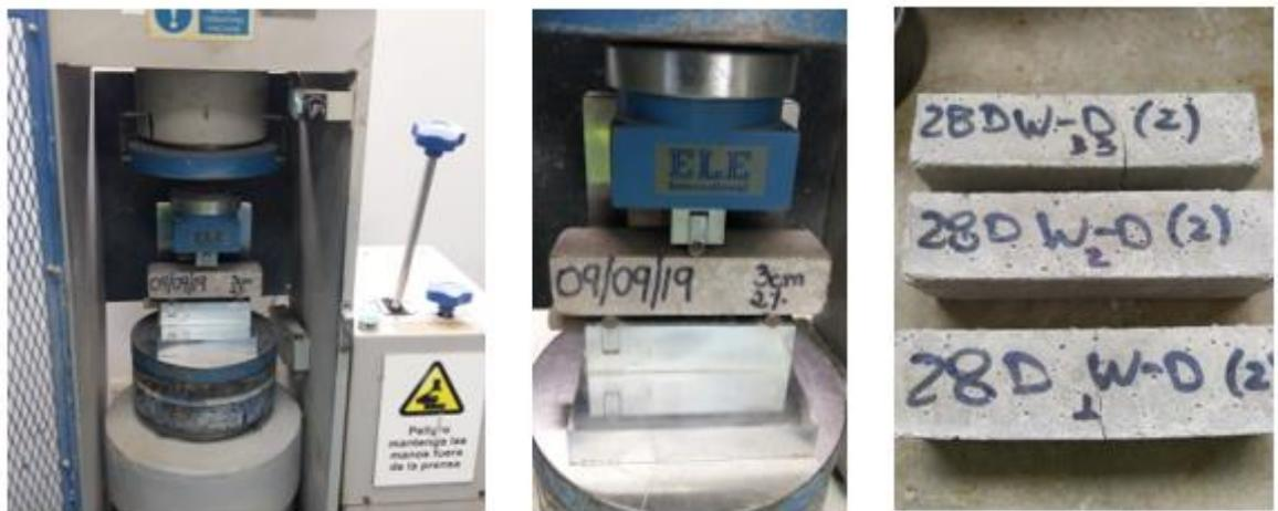
Ilustración 40 Procedimiento de ensayo a flexión
