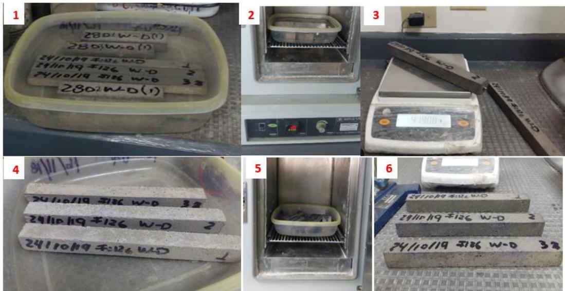
Ilustración 16 Proceso de envejecimiento Wet and Dry según (Neves et al., 2019)
