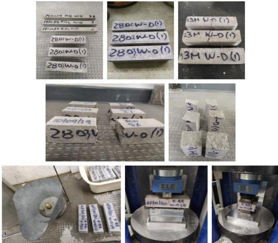
Ilustración 56 Serie de ensayos para envejecimiento W-D(1)
