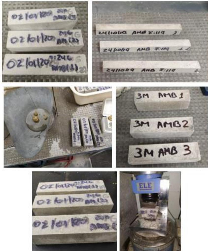
Ilustración 46 Serie de ensayos para envejecimiento en ambiente laboratorio
