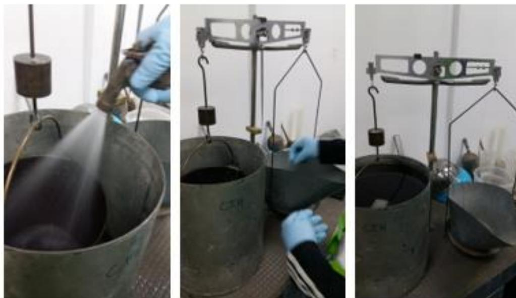
Ilustración 36 Determinación de la masa sumergida
