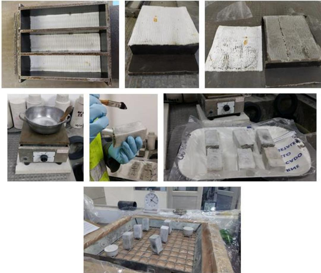
Ilustración 38 Procedimiento para ensayo de coeficiente de absorción de agua (Capilaridad)
