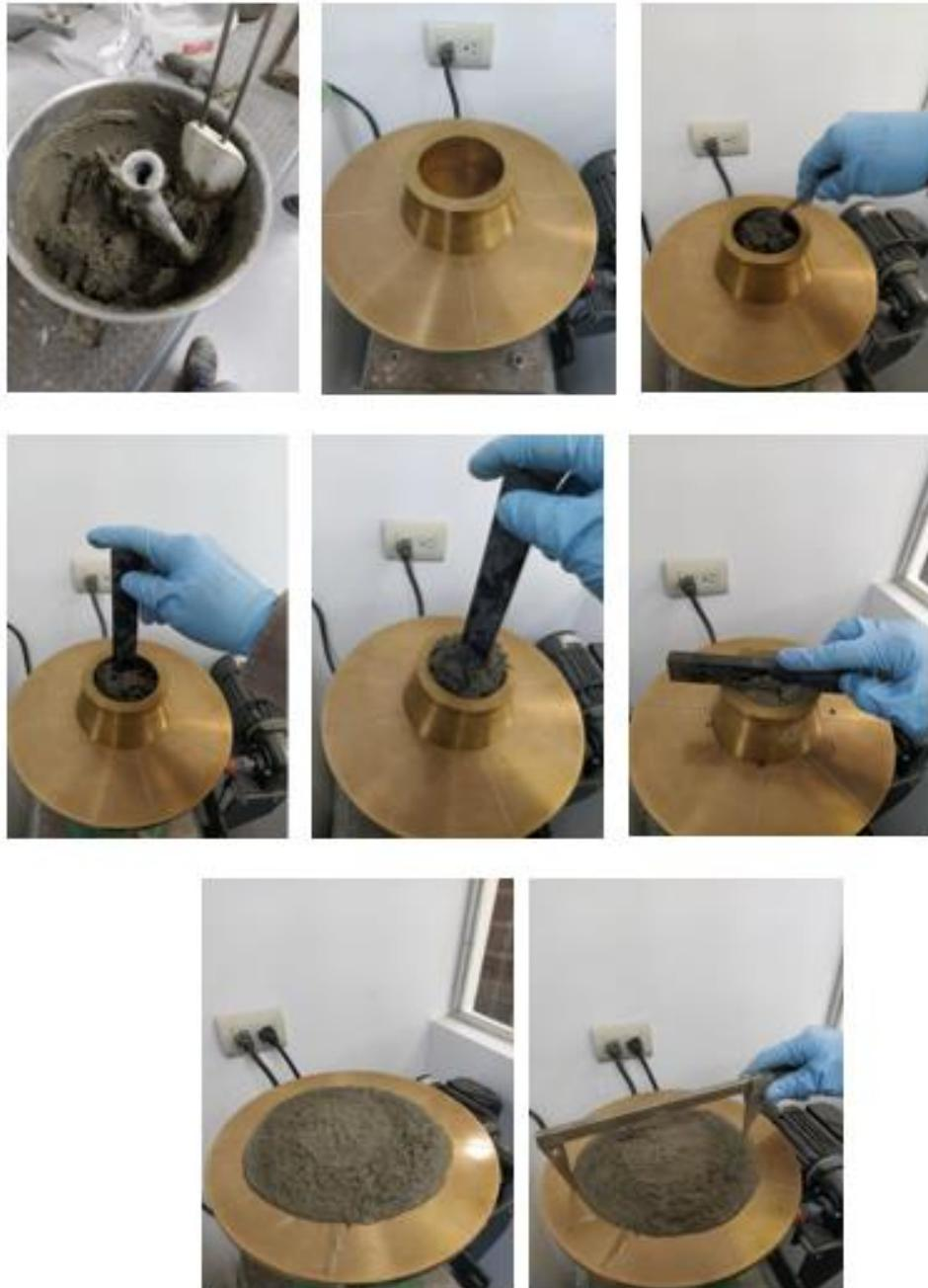
Ilustración 30 Procedimiento del ensayo de flujo en estado fresco del mortero
