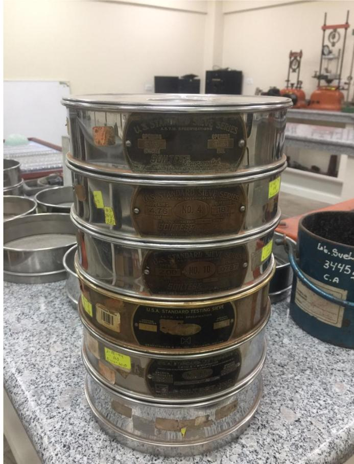
Figura 6.- Tamices utilizados para el análisis granulométrico.
