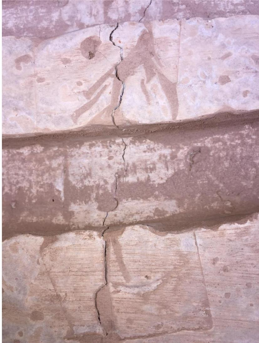
**Figura 24.- Grieta provocada por flexión de la Placa Plana UCSG.
