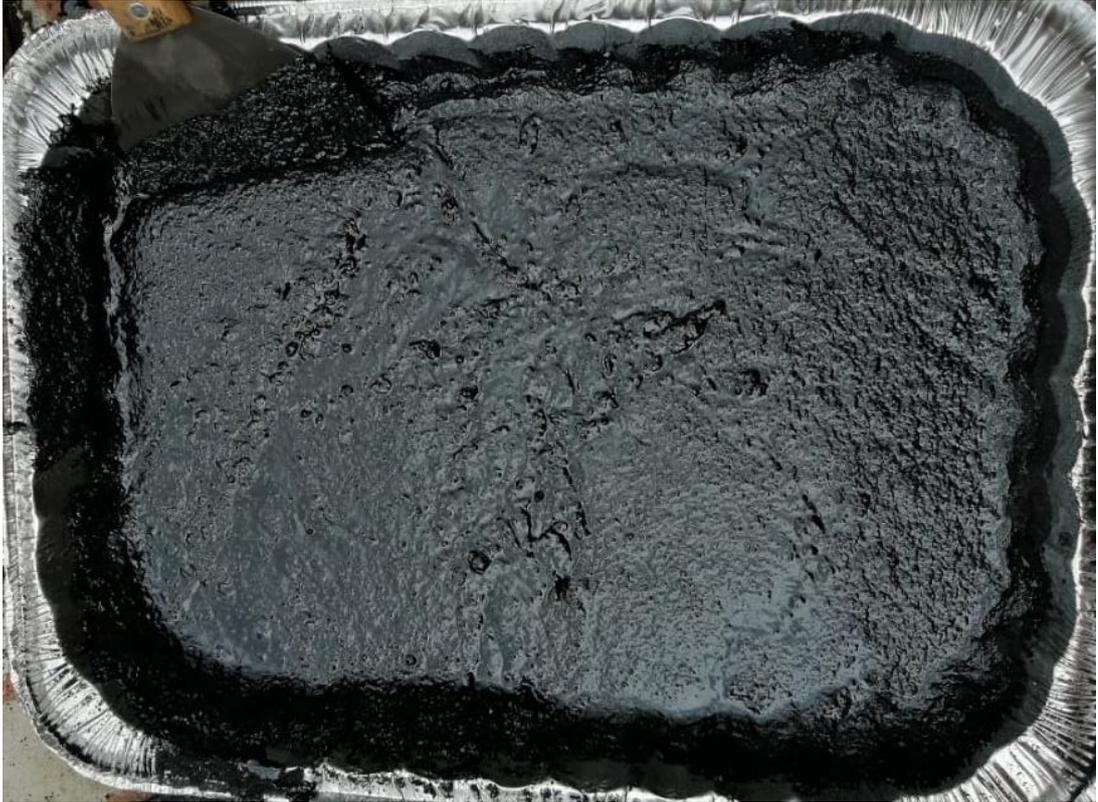
**Figura 27.- Pasta impermeabilizante de harina de llanta con imprimante asfáltico.
