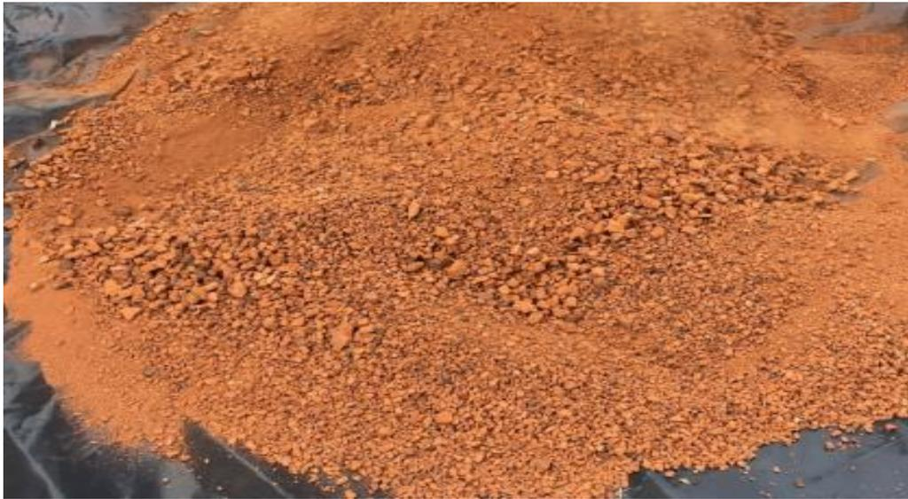
**Figura 9.- Áridos mezclados, dosificación todo uno.
