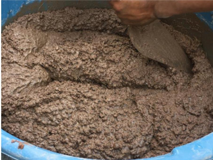
**Figura 13.- Mezcla de concreto ligero de la alternativa uno.
