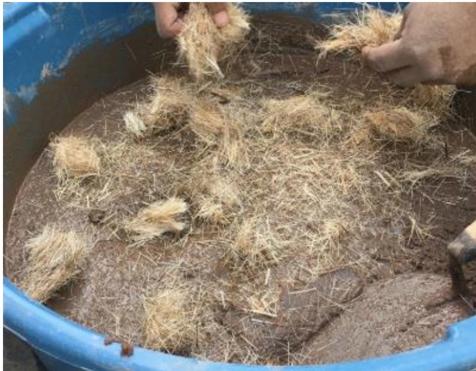
**Figura 12.- Adición de las fibras de abacá en la mezcla de concreto en la alternativa uno.**
