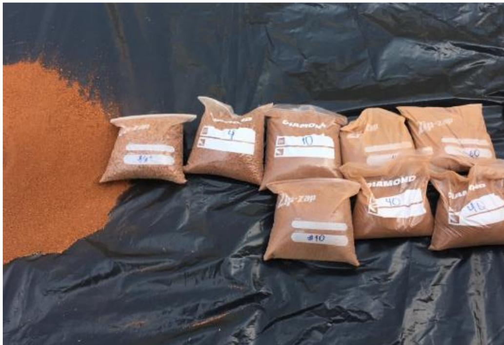
Figura 7.- Almacenamiento del material triturado según el tamaño de las partículas.
