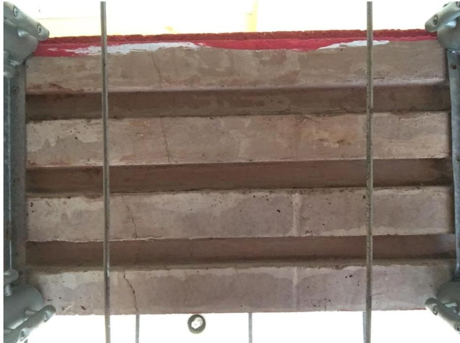
**Figura 34.- Placa Plana UCSG quince días después, durante la ejecución de la prueba de permeabilidad.
