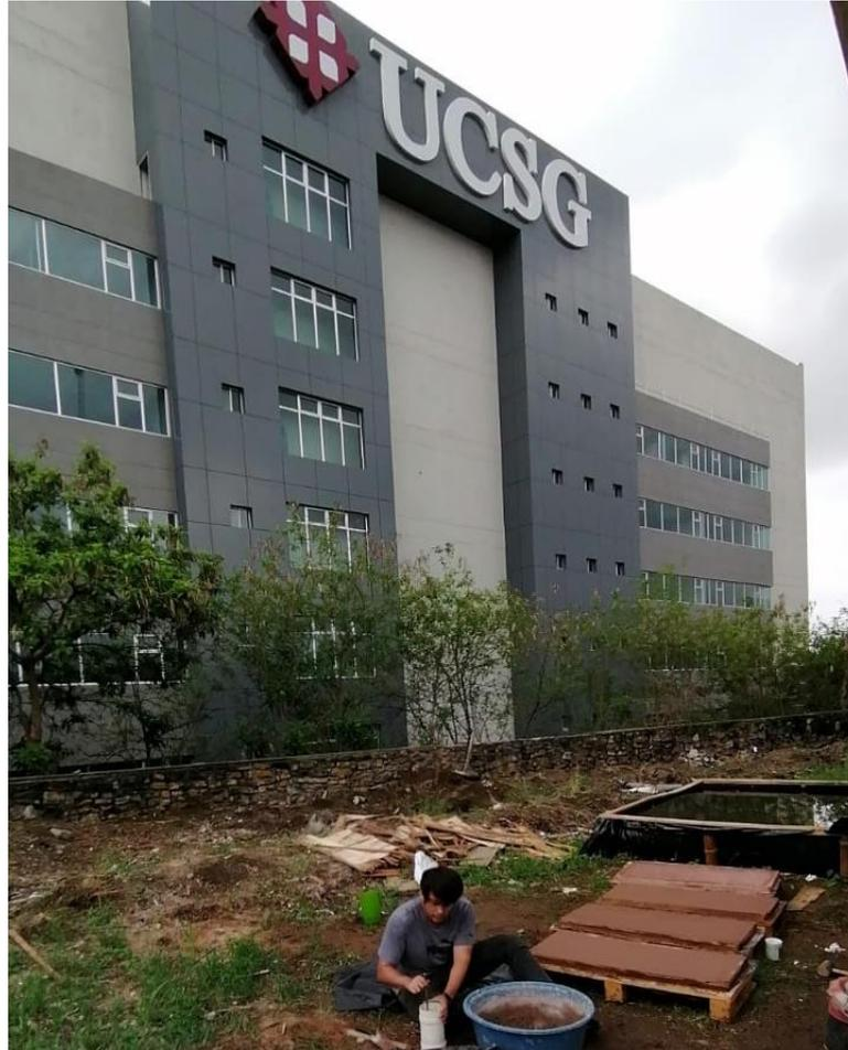
**Figura 16.- Preparación de las probetas para los ensayos a compresión simple para la alternativa dos.**
