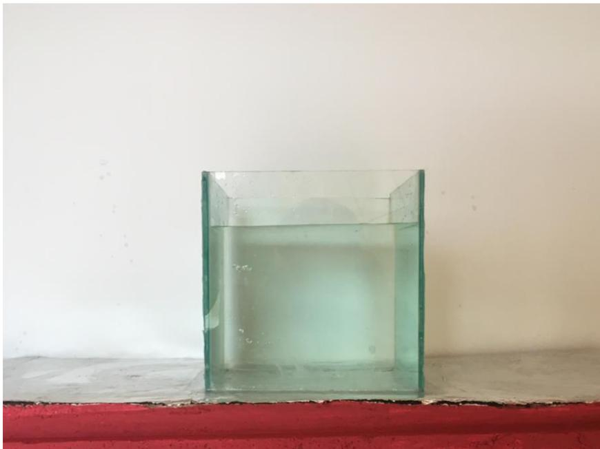
**Figura 33.- Permeámetro para placa plana experimental.
