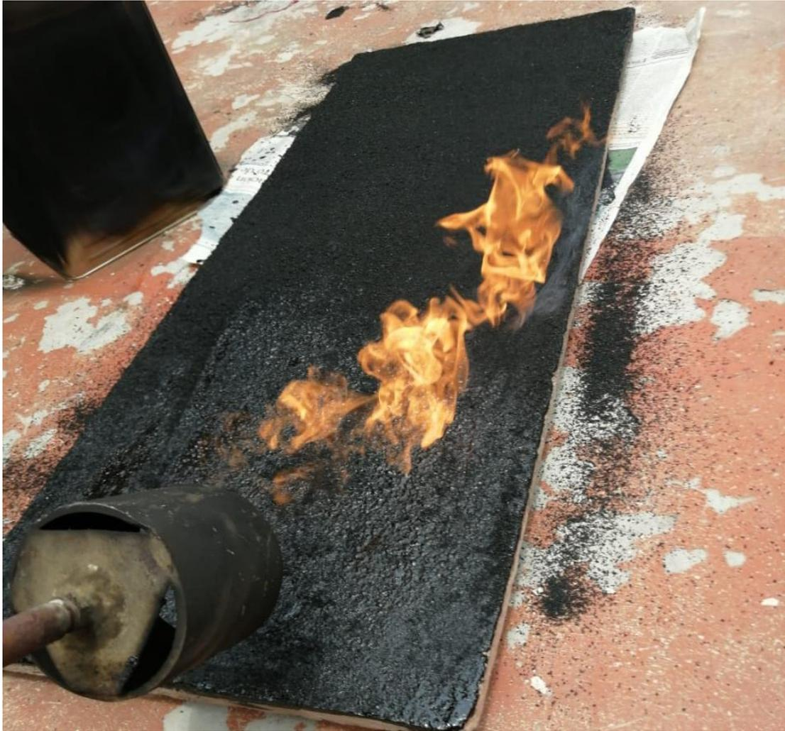
**Figura 29.- Incremento de la temperatura de la capa impermeabilizante para adherencia en placa.
