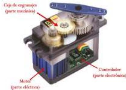
Figura 2. 13: Partes de un servomotor.
