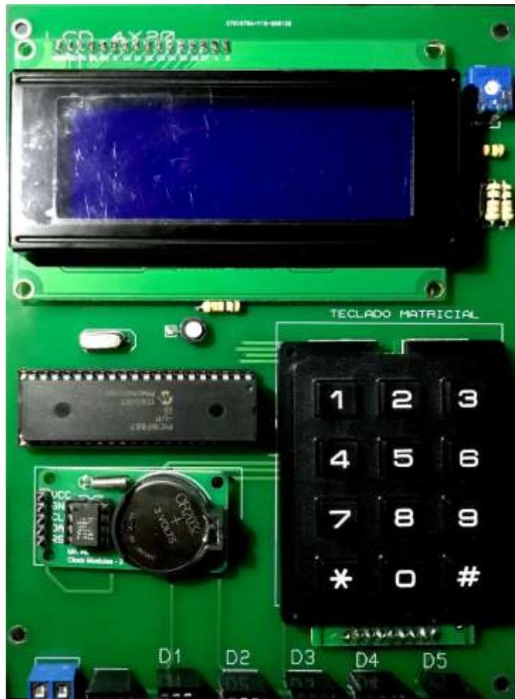
Figura 3. 38: Placa de circuito ensamblada.
