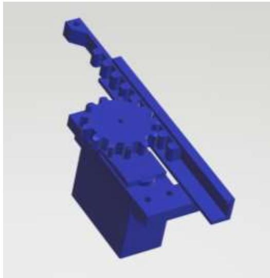
Figura 3. 3: Vista superior-lateral izquierda del montaje del servomotor.
