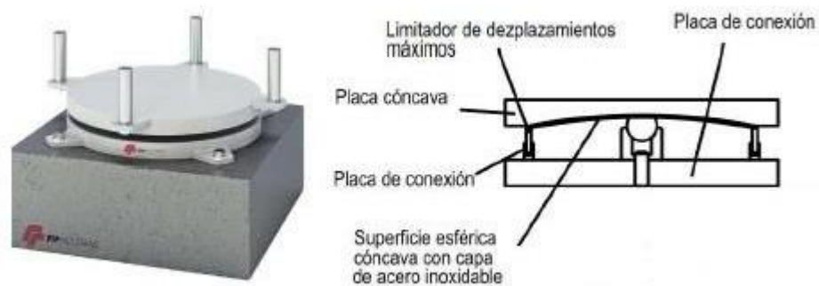
Ilustración 12 Aislador Péndulo Friccional.
