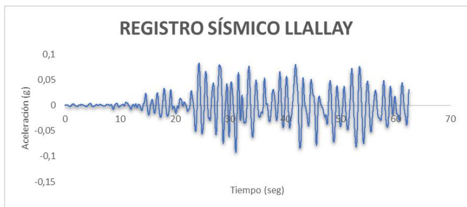
Ilustración 43 Gráfica de aceleración de la superficie del terreno vs tiempo correspondiente al registro sísmico LLALLAY
