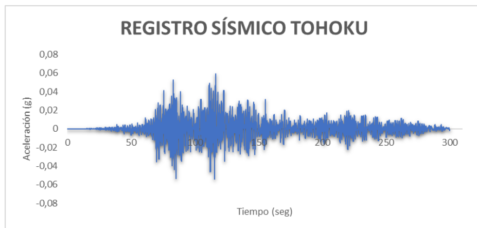
Ilustración 40 Gráfica de aceleración de la superficie del terreno vs tiempo correspondiente al registro sísmico TOHOKU
