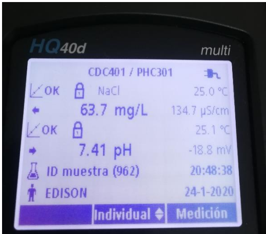
Ilustración 137.- Resultado de sólido disuelto y pH a través del multiparámetro del agua proveniente de la vivienda 5.
