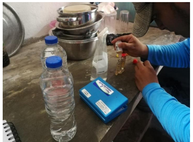
Ilustración 131.- Ejecución del ensayo de cloro en la vivienda 4.
