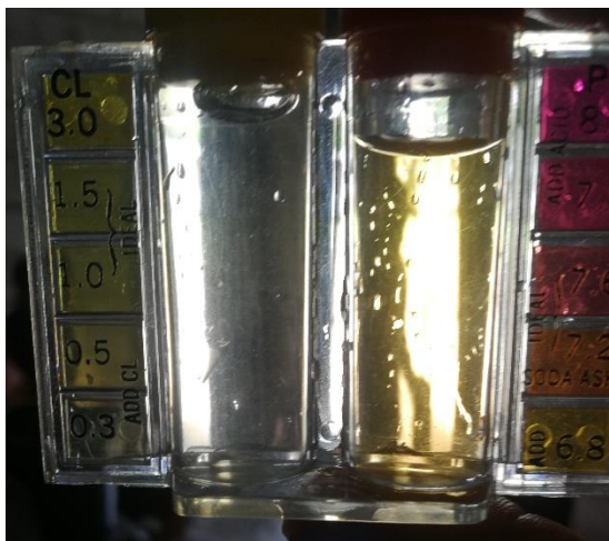
Ilustración 130.- Ensayo de cloro del agua proveniente de la vivienda 5.
