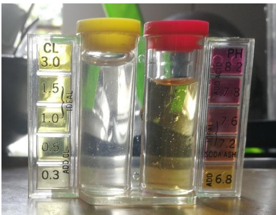
Ilustración 128.- Ensayo de cloro del agua proveniente de la vivienda 1.
