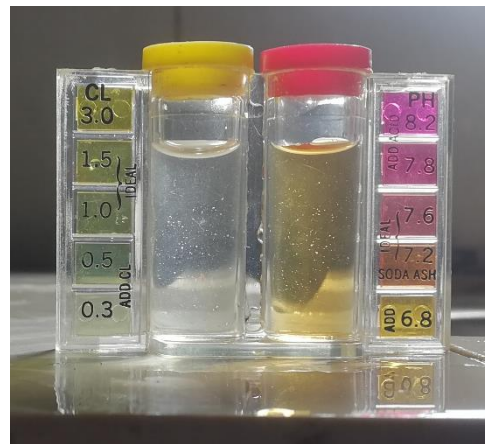
Ilustración 129.- Ensayo de cloro del agua proveniente de la vivienda 4.
