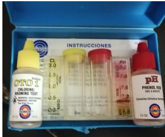
Ilustración 132.- Equipo de medición de cloro en campo.
