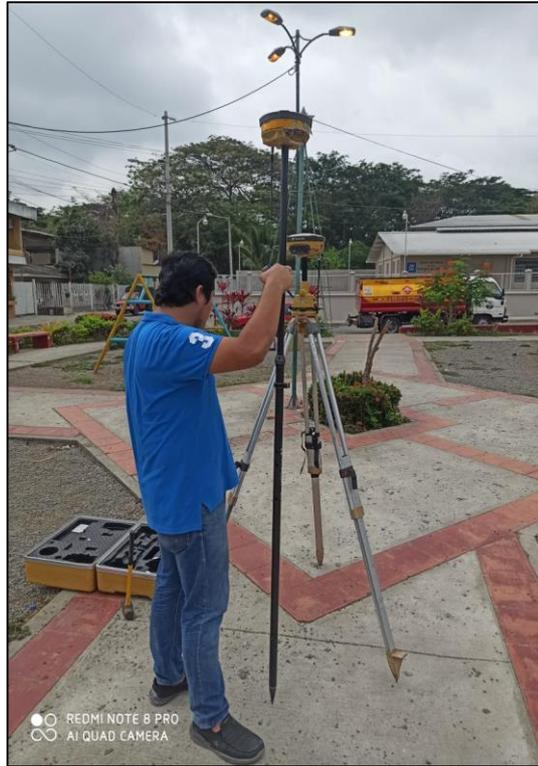
Figura 7.5 Toma de puntos bases con GPS Top Com.
