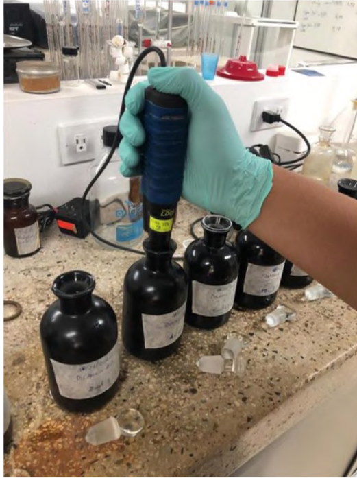
Fotografía 25: Medición del oxígeno inicial del DBO.
