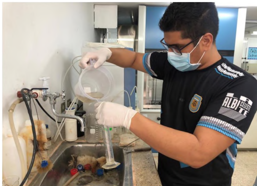
Fotografía 14: Realización de ensayos de Sólidos Suspensos.
