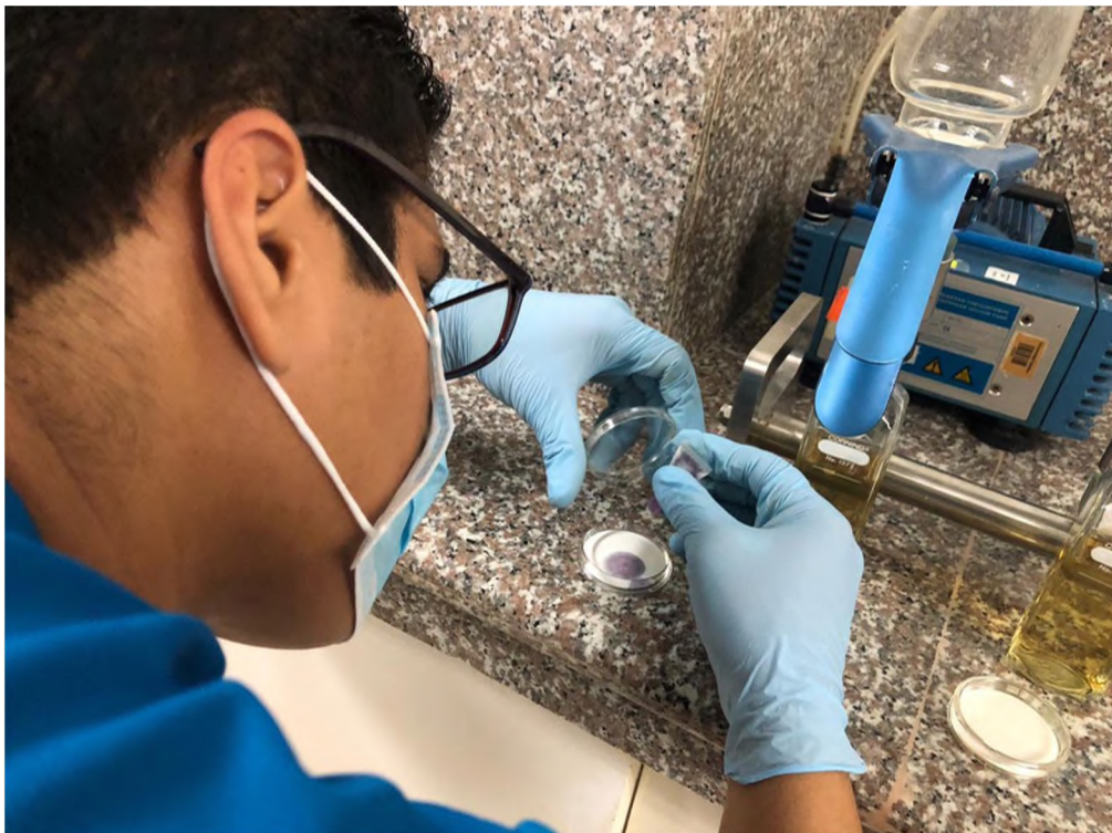
Fotografía 26: Colocación de medio de cultivo en Cajas Petri.
