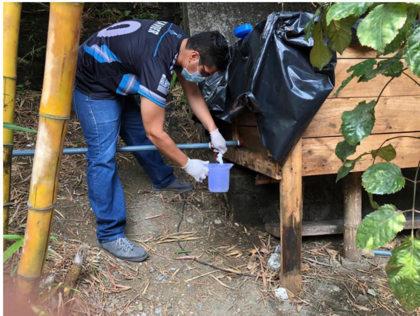
Fotografía 12: Obtención de muestra de Efluente de Planta Piloto.
