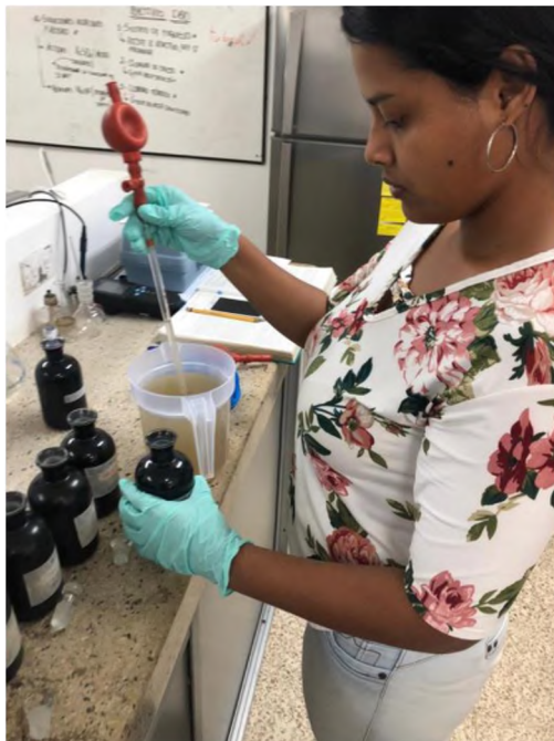
Fotografía 24: Extracción de muestra a colocar en botellas winkler de ensayos de DBO.
