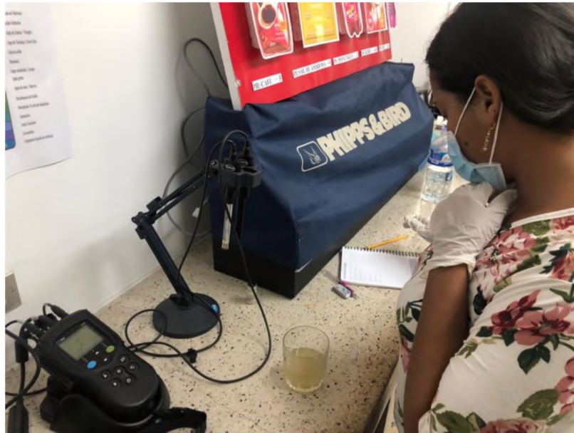
Fotografía 21: Técnica de muestreo con equipo Hach de los cuales se miden parámetros como pH, temperatura, conductividad, sólidos disueltos.
