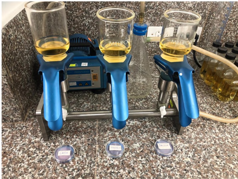
Fotografía 28: Solución con muestra de Caja de Registro, efluente de tanque homogeneizador, y efluente de descarga.
