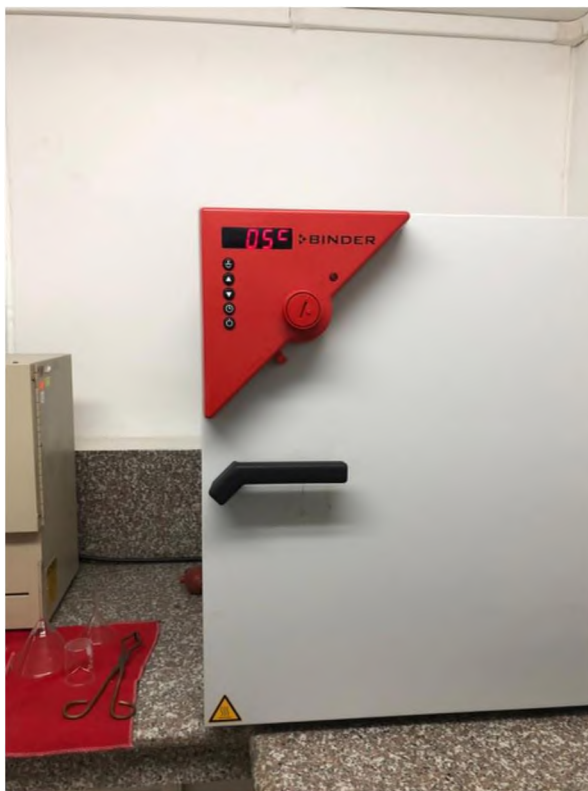
Fotografía 18: Muestra colocada al horno a 105 °C.
