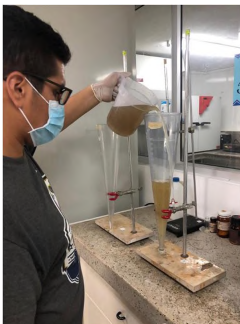
Fotografía 20: Prueba de Sólidos Sedimentables.
