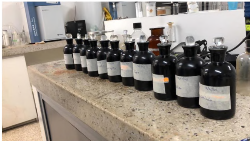
Fotografía 22: Realización de Ensayo de DBO 5 .
