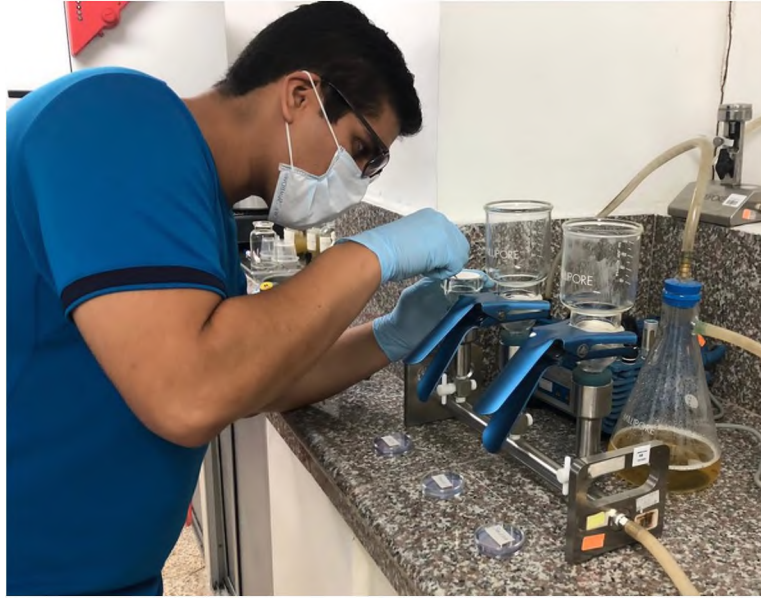
Fotografía 27: Colocación de Filtro para realización de Prueba de Coliformes Fecales.
