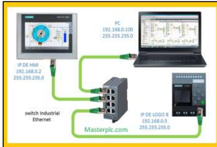
**Figura 4. 9. Diagrama de conexión de HMI**
