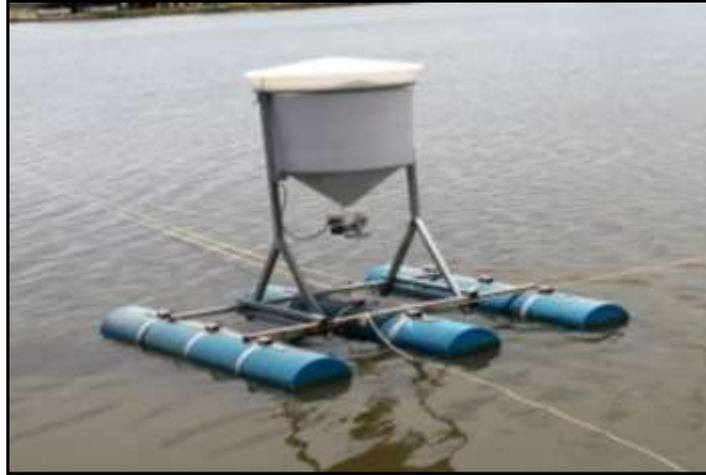
**Figura 3. 2. Alimentador autónomo para camarón**
