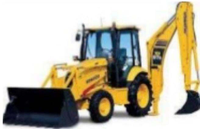
*Figura 12. Retroexcavadora. Adaptado de: Freespiritusa.*
