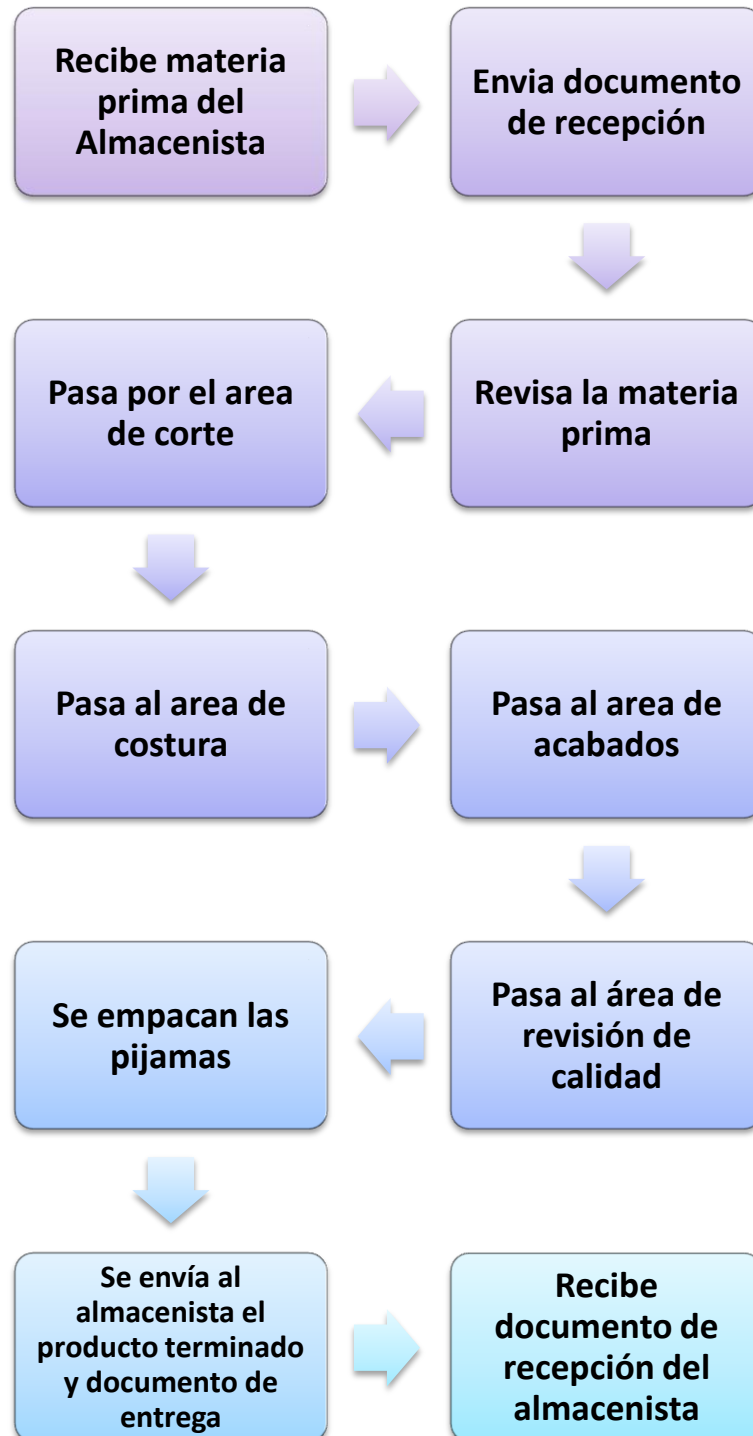
Ilustración 41 Diagrama de Flujo Producción
