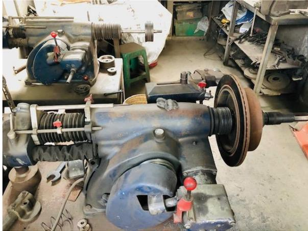
*Figura 64* Máquina pulidora de discos de frenos
