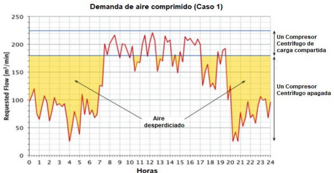
Figura 2. 39 Purga de aire con un solo compresor centrífugo de 220 m<sup>3</sup>/min.
