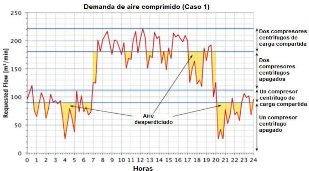
Figura 2. 41 Purga de aire con dos compresores centrífugos de 110 m<sup>3</sup>/min con control de reparto de carga
