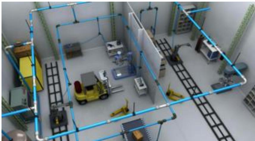
Figura 3. 6 Red de aire comprimido tipo cerrada
