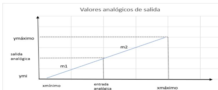
Figura 4: Escalamiento de señal analógica.
