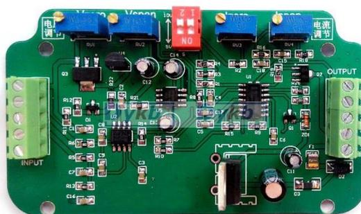
**Figura 3. 8:** Sensor de Voltaje & Corriente input
