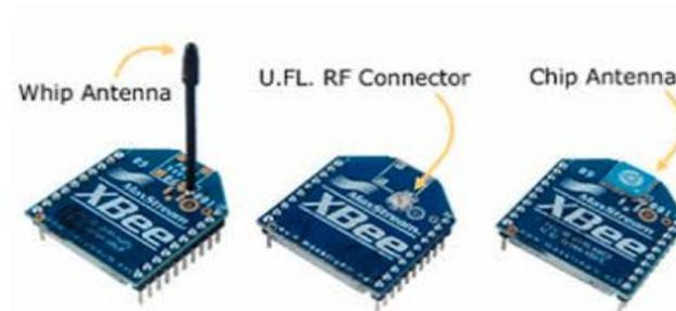
**Figura 2. 10:** Tarjetas Zigbee
