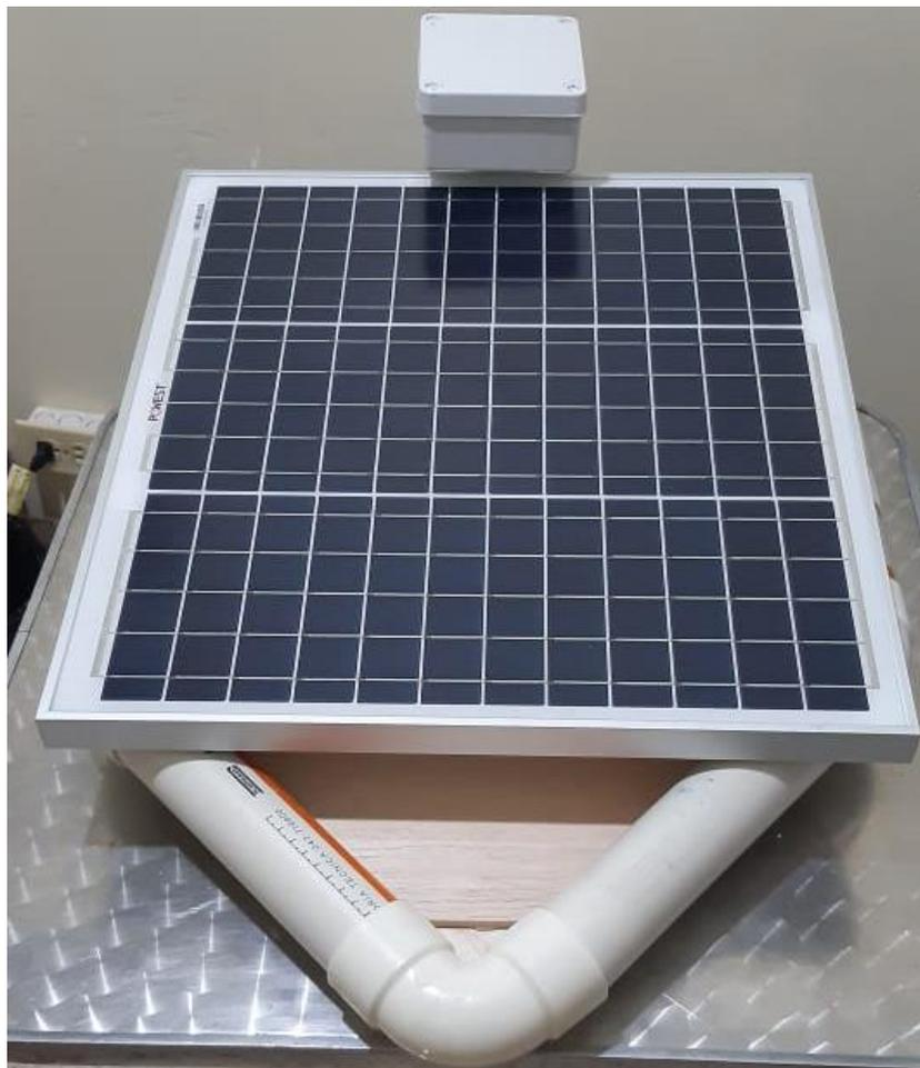
**Ilustración 16:** *Instrumento (barco) terminado*
