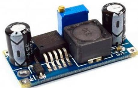
**Figura 3. 6:** *Regulador de voltaje Step Down 3A DC*
