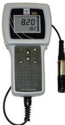
**Figura 2. 19:** Medidor de oxígeno de la marca YSI
