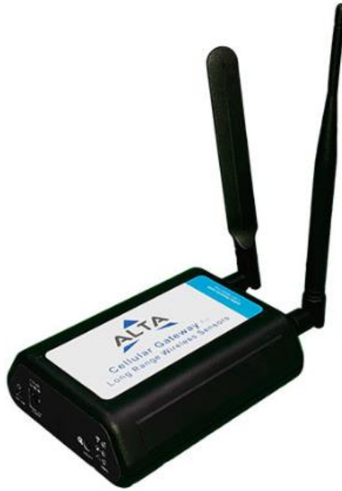
Figura 3.5: Puerta de enlace 4G LTE Alta
