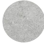
Distribuido en paños de 3x3m se configura el recorrido peatonal principal de las aceras de las vías. Las ventajas que posee son las de poder ser fundido fácilmente en paños o formas irregulares, fácil mantenimiento y alta resistencia a la abrasión
