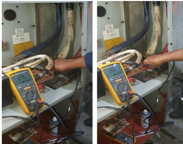
LSTSGU 200 / (BLANCO) L1 - 2.70 MΩ LSTSGU 200 / L2 (ROJO) - 2.59 MΩ
