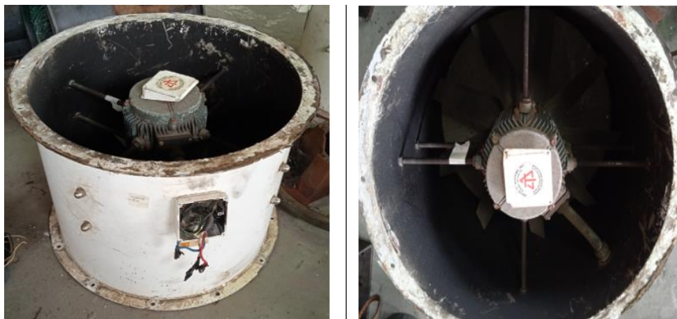
Figura 3. 1 motor de ventilación-extracción del estribor de un remolcador.
