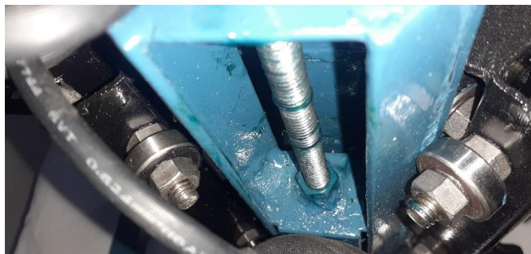
Figura 3.26: Sistema de transmisión correspondiente al eje z Fuente: El autor
