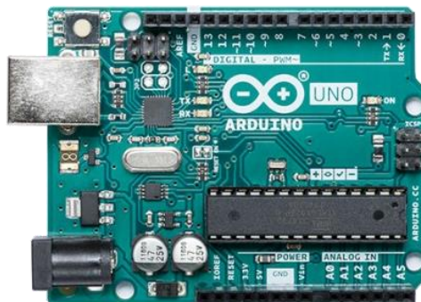
Figura 2.7: Placa arduino uno basada en el microcontrolador ATME328P Fuente: https://arduino.cl/producto/arduino-uno/
