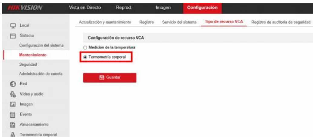
Figura 3. 11: Configuración de termometría corporal
