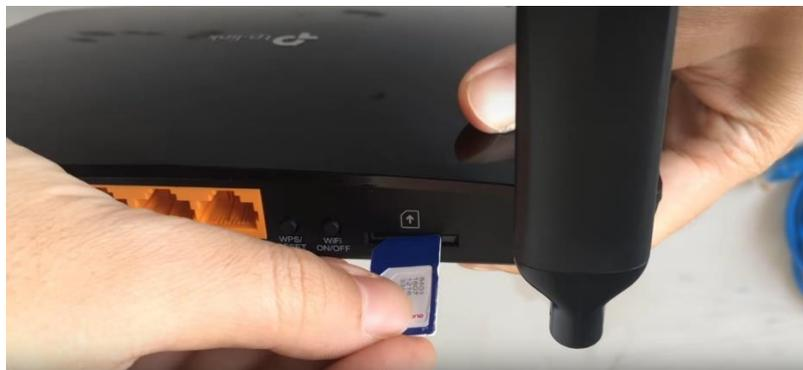
**Figura 3.3:** Inserción de Tarjeta SIM en ranura especificada
