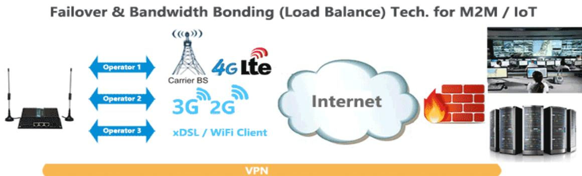
**Figura 2.40:** Conmutación por error y enlace de ancho de banda (equilibrio de carga) para M2M / lote
