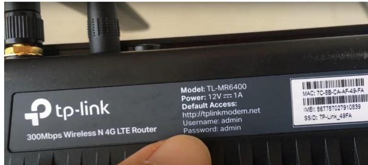
**Figura 3.4:** Dirección web <http://tplinkmodem.net>, localizada en menú posterior del Router
