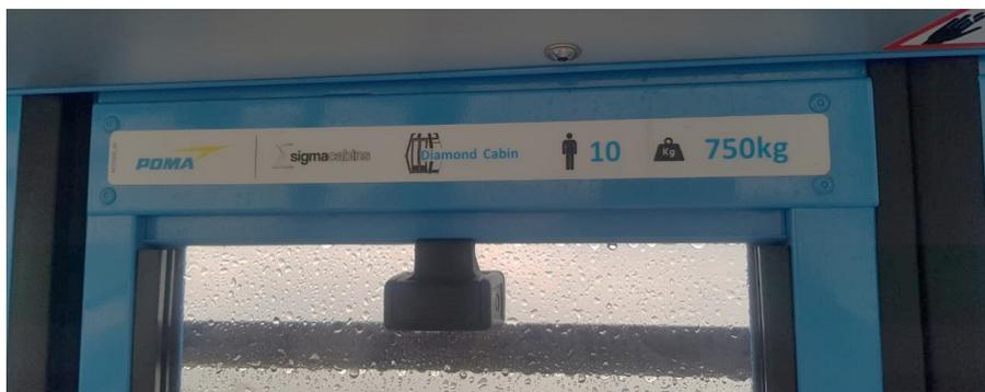
**Figura 3.13:** Especificaciones de máxima capacidad y peso dentro de la cabina
