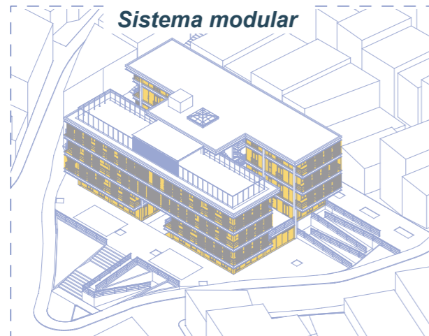
Unidades de vivienda conformadas por paneles prefabricados de fibrocemento de 1.22x2.44m
