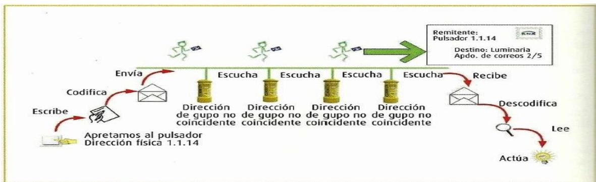
FIGURA 2.32 ESQUEMA DE TRANSMISIÓN Y RECEPCIÓN ENTRE COMPONENTE
