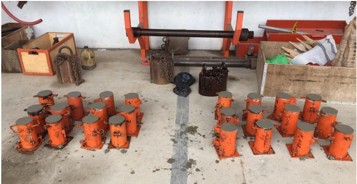
Imagen 5. Encofrado de los especímenes de hormigón de 400 y 450 kg/cm 2 . Fuente: Autor.
