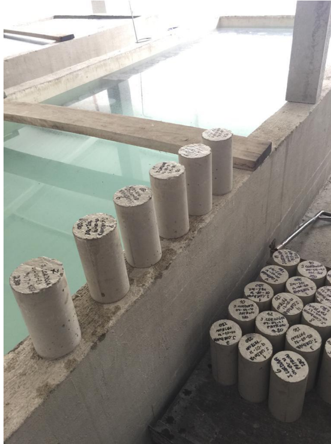
Imagen 6. Desencofrado y colocación de las muestras de hormigón en piscina de curado.
