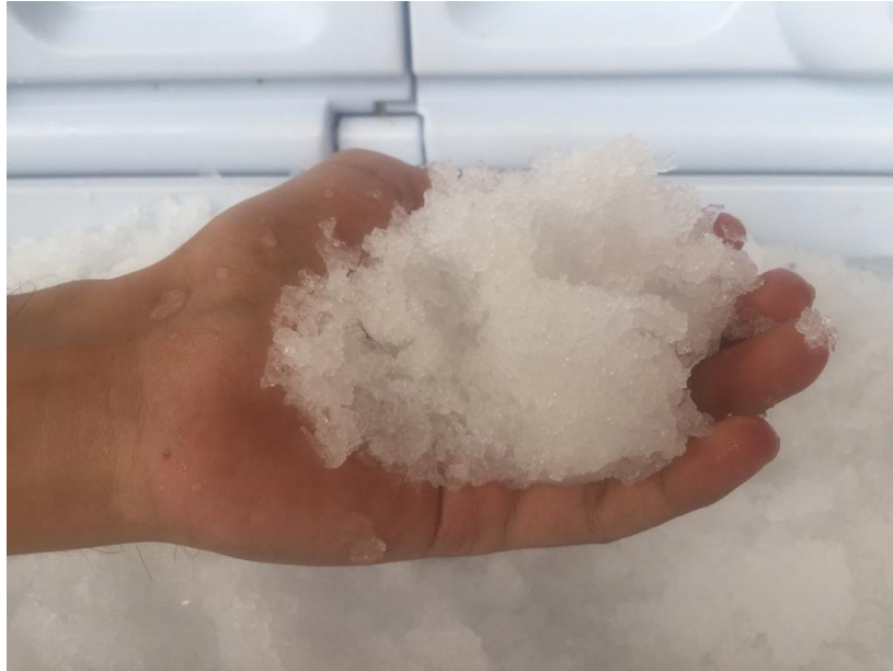
Imagen 4. Almacenamiento del hielo en escamas que se utilizó en la elaboración de hormigón. Fuente: Autor.
