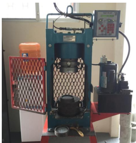
Imagen 7. Máquina de ensayo utilizado para determinar la resistencia a la compresión de los especímenes de hormigón.
