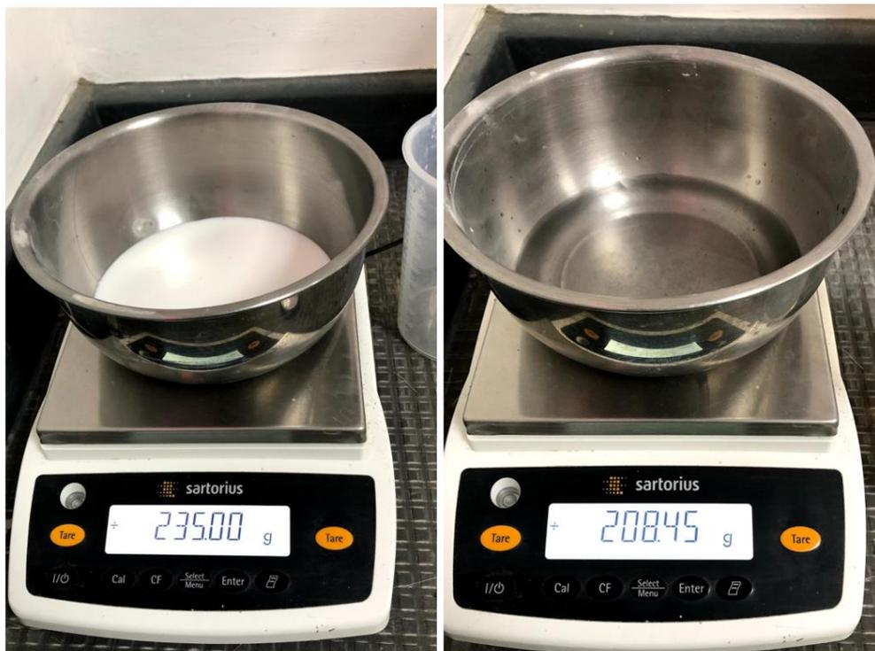
Ilustración 15 Se pesan los dos componentes necesarios para mezclarlos y tener la solución adherente.
