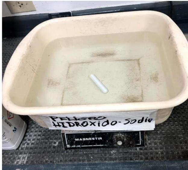
Ilustración 7 Mesa magnética utilizada para disolución del NaOH.
