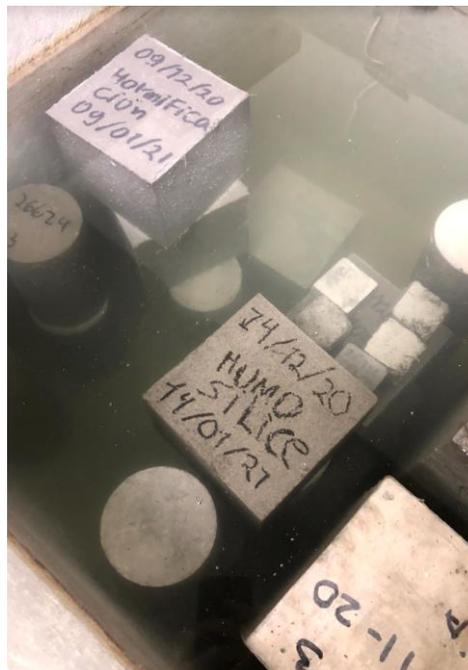
Ilustración 33 Muestras sumergidas en piscina de curado.
