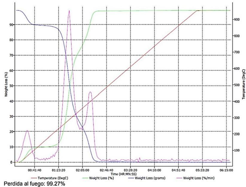
Ilustración 34 Resultado de ensayo TGA, fibra de abacá en estado natural (fibra 1).
