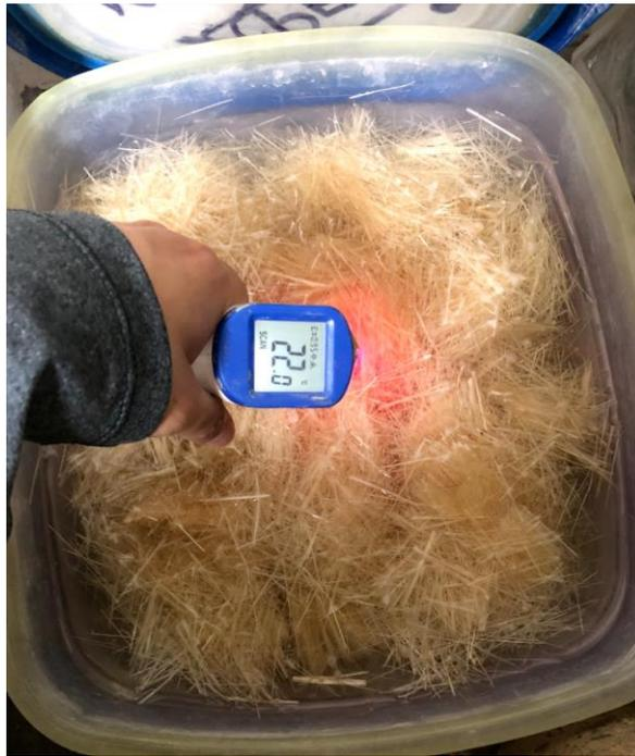
Ilustración 20 Fibra sumergida en agua que tiene una temperatura de 22°C.
