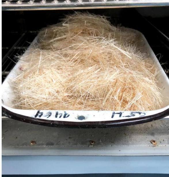
Ilustración 16 Se deja la fibra en el horno a 100°C por 2 horas.
