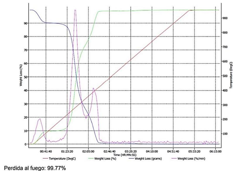
Ilustración 35 Resultado de ensayo TGA, fibra de abacá en estado natural (fibra 2).
