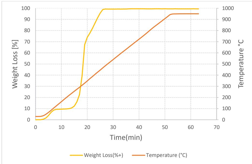
Ilustración 38 Resultado de ensayo TGA, fibra de abacá tratada con hornificación (fibra 5).
