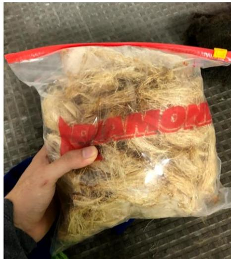
Ilustración 14 Se coloca la fibra en una funda de cierre hermético.
