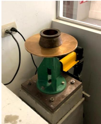
Ilustración 43 Limpieza de mesa de golpes y el molde troncocónico.
