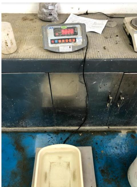
Ilustración 6 Pesado de agua de 5820 gr en el recipiente de la solución.
