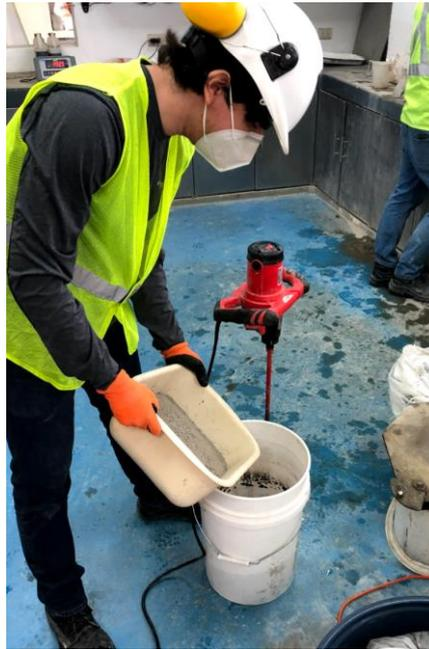
Ilustración 25 Se vierte el cemento en el recipiente.
