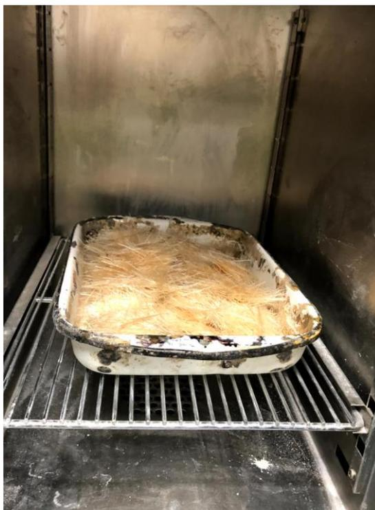
Ilustración 21 Se coloca la fibra en el horno a una temperatura de 80°C.
