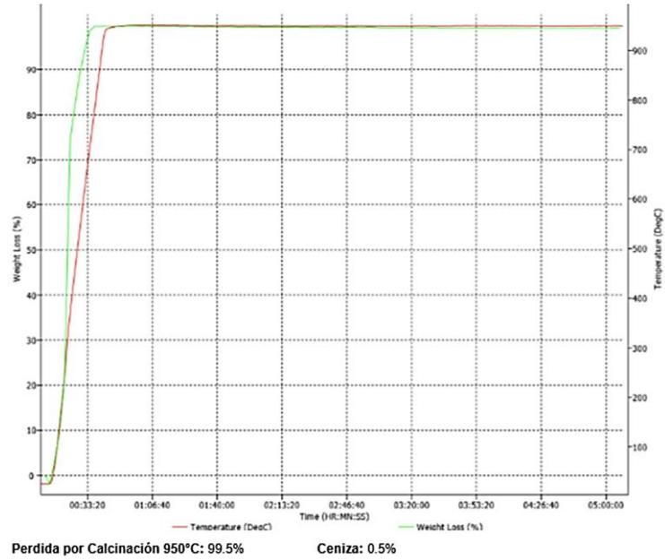
Ilustración 36 Resultado de ensayo TGA, fibra de abacá tratada con NaOH (fibra 3).
