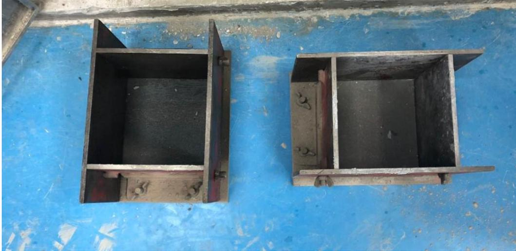
Ilustración 29 Moldes para ensayo de conductividad térmica.
