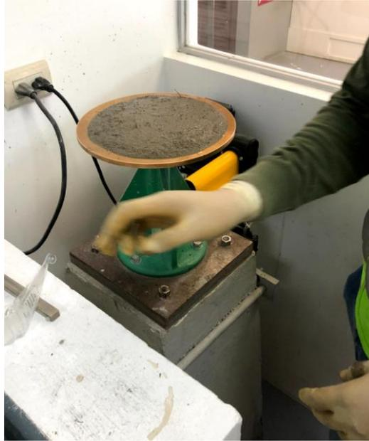
Ilustración 46 Aplicación de 25 golpes para ensayo de flujo.
