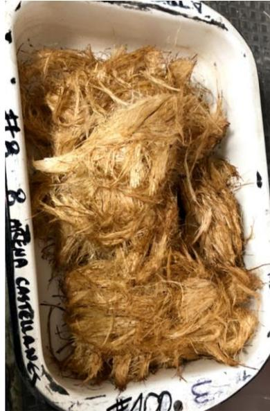
Ilustración 13 Colocamos la fibra en un recipiente metálico para ubicarlo en el horno.
