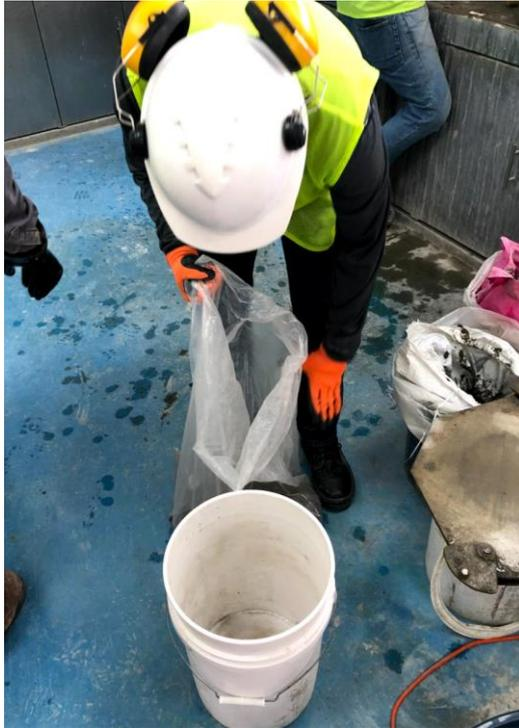
Ilustración 23 Se humedece con agua el recipiente donde se realizará el amasado.
