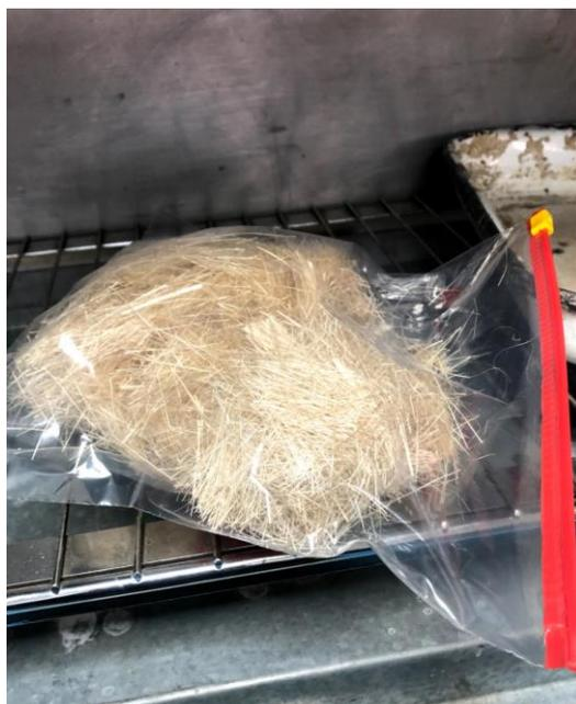
Ilustración 22 Se guarda la fibra tratada en una funda hermética.
