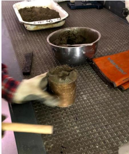
Ilustración 49 Aplicación de golpes para eliminar el aire atrapado.
