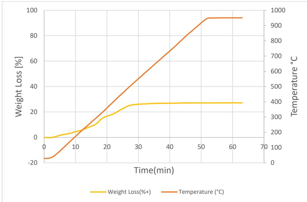
Ilustración 40 Resultado de ensayo TGA, fibra de abacá tratada con humo de sílice (fibra 7).
