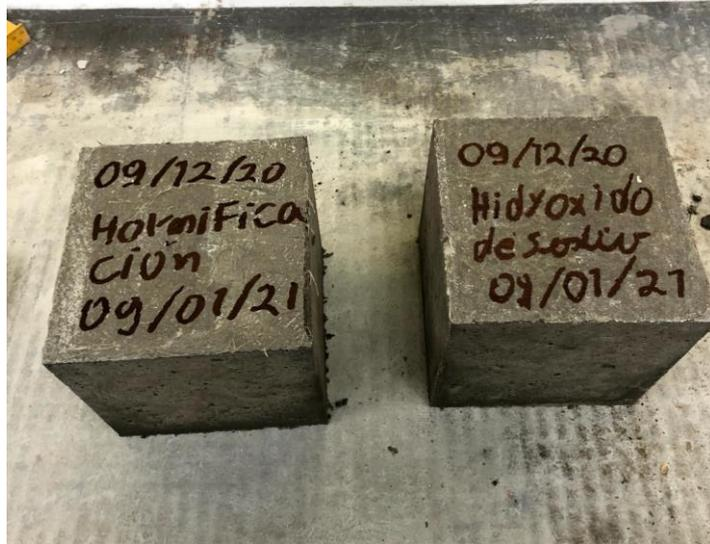
Ilustración 32 Se desmoldan las muestras y se limpian los moldes.
