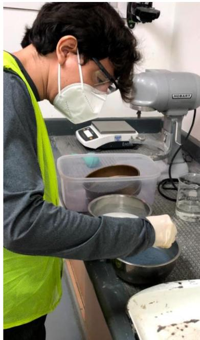
Ilustración 17 Se cubre de humo de sílice la fibra previamente sumergida en el adhesivo.
