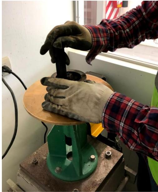
Ilustración 44 Aplicación de golpes a la primera capa de mortero.
