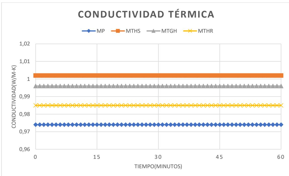
Ilustración 51 Resultados de la conductividad térmica de las muestras.
