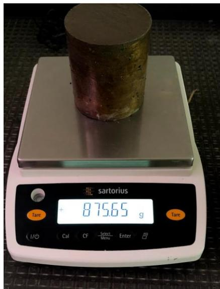
Ilustración 50 Determinación de la masa del mortero.
