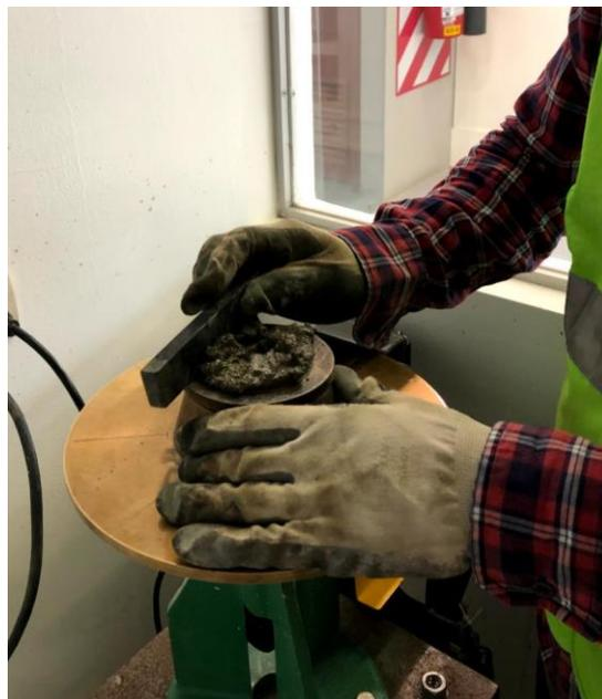
Ilustración 45 Enrasado de molde para ensayo de flujo.
