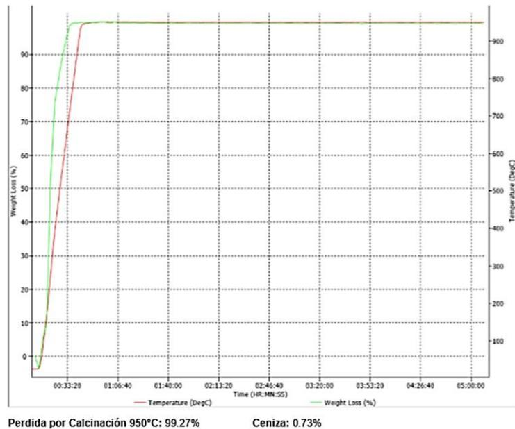
Ilustración 37 Resultado de ensayo TGA, fibra de abacá tratada con NaOH (fibra 4).
