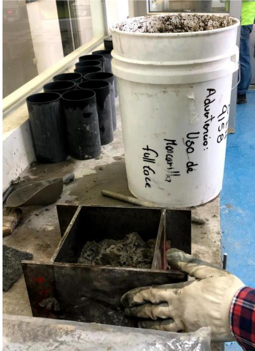
Ilustración 30 Proceso de elaboración de muestras, primera capa.
