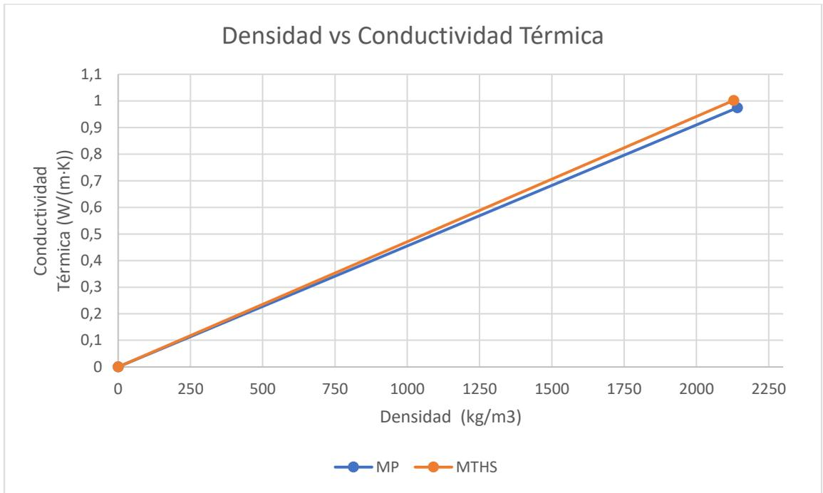
Ilustración 53 Gráfica Densidad vs Conductividad Térmica.
