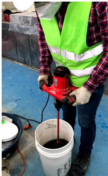
Ilustración 24 Se mezcla la arena para que sea uniforme la caracterización.
