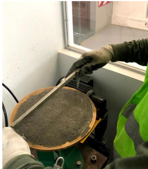
Ilustración 47 Toma de mediciones para determinar el flujo de la mezcla.
