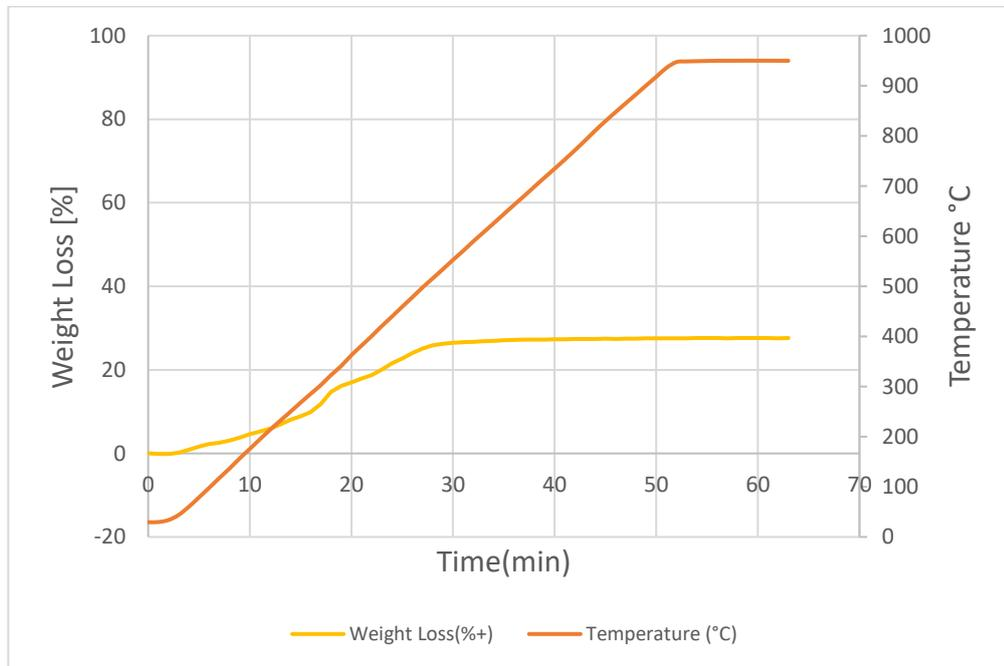
Ilustración 41 Resultado de ensayo TGA, fibra de abacá tratada con humo de sílice (fibra 8).
