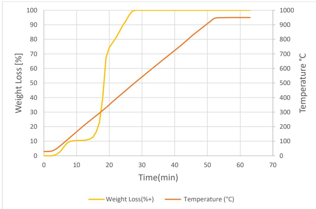
Ilustración 39 Resultado de ensayo TGA, fibra de abacá tratada con hornificación (fibra 6).
