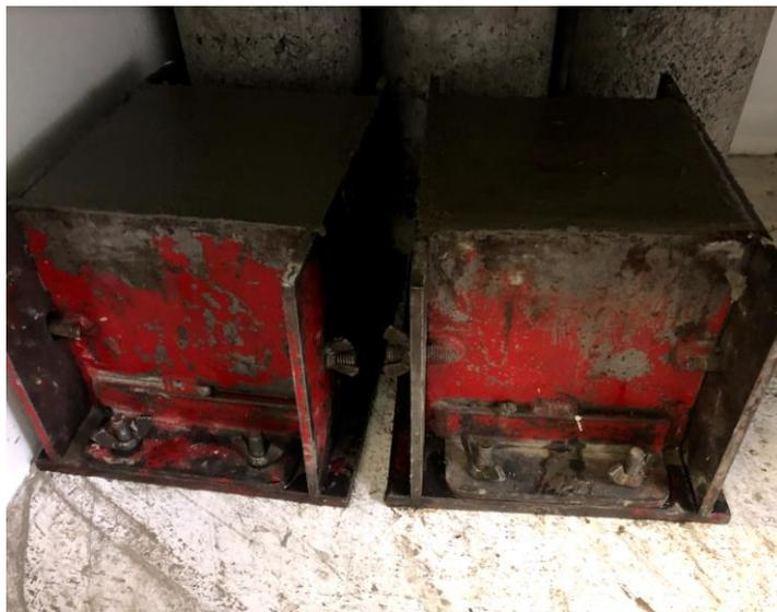
Ilustración 31 Muestras enrasadas y terminadas.
