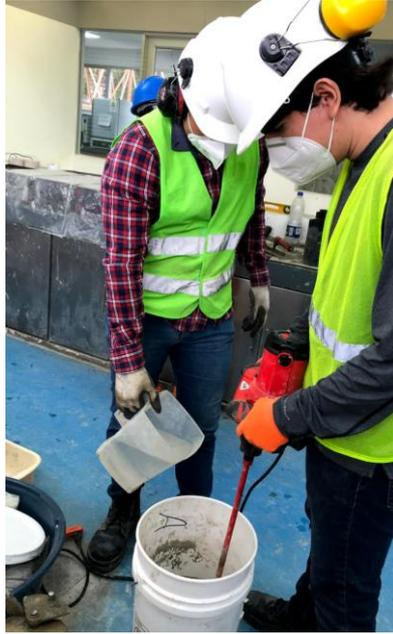
Ilustración 27 Se vierte la otra mitad del agua en la mezcla.
