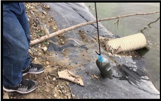
Foto # 11: Toma de muestra en la tubería de ingreso en la laguna facultativa.
