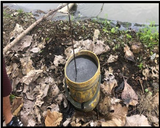
Foto # 13: Mediciones de caudales por el método Volumétrico.
