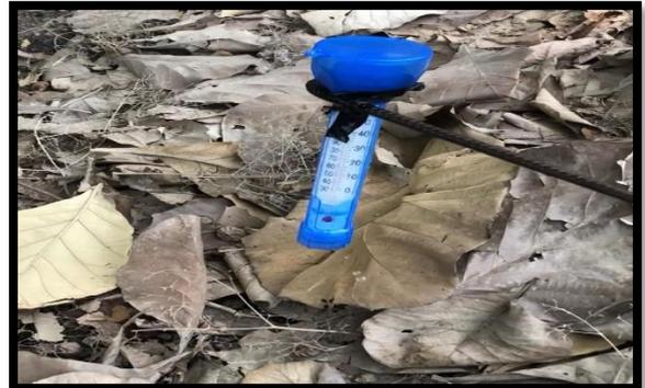
Foto # 12: Termómetro para piscina, usado para tomar la temperatura en las lagunas de oxidación.
