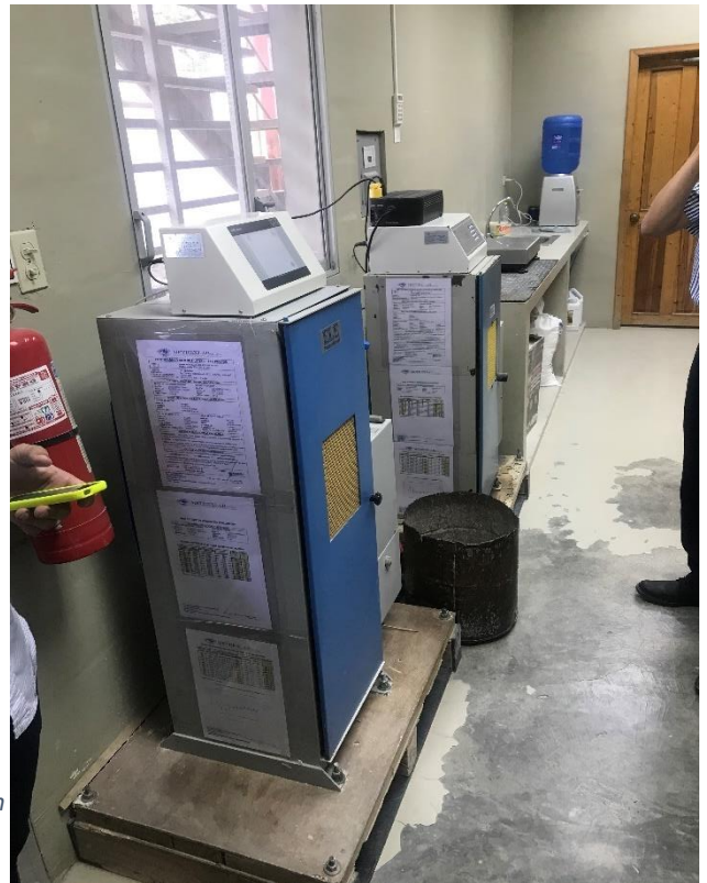
Ilustración 48 Máquina para realizar los ensayos a compresión de cada probeta de prueba que escogen al momento del realizar la fundición del elemento. Fuente: Autor de tesis.
