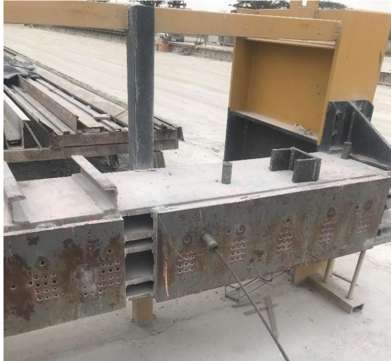
Ilustración 29 Orificios por donde se tensan los torones del alambre de la fábrica Ditelme. Fuente: Autor de tesis.
