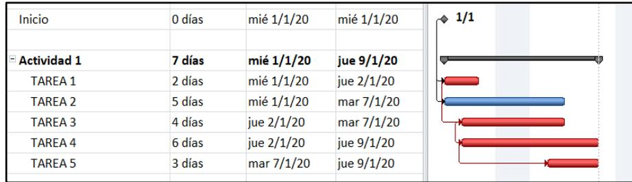
**Figura 40** Ejemplo fast tracking – Nueva ruta crítica
