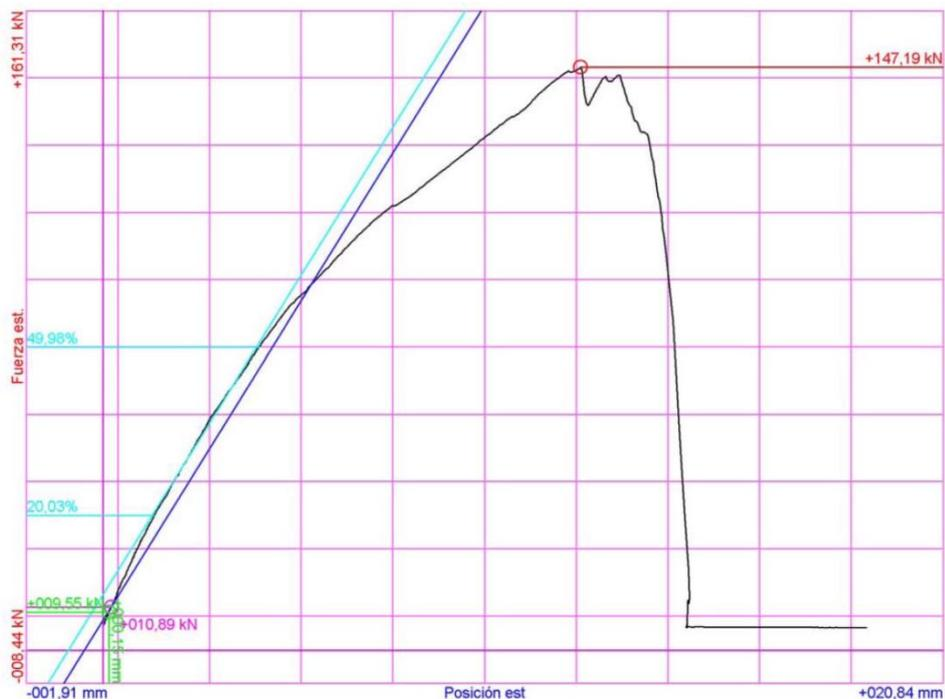
Figura 33: Resultado de ensayo a tracción de las varillas GFRP de  $\varnothing$  16mm.
