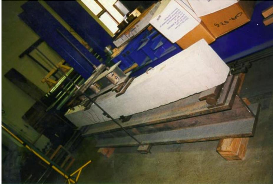
Figura 24: Ensayo de viga a carga sostenida empleando barras de tensión Dywidag. (Vijay, 1999).
