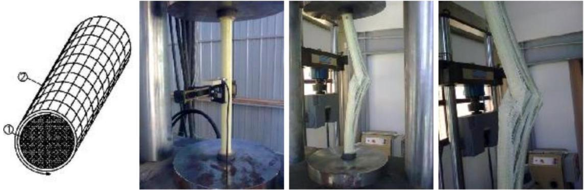
Figura 19: Ensayo a compresión de varilla GFRP con rollos e hilos transversales. (Rovira, Almerich, Molines & Martin, 2012).
