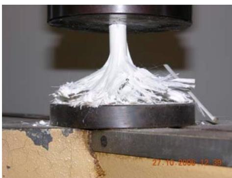
Figura 18: Ensayo a compresión de varilla GFRP. (Almerich, 2010).
