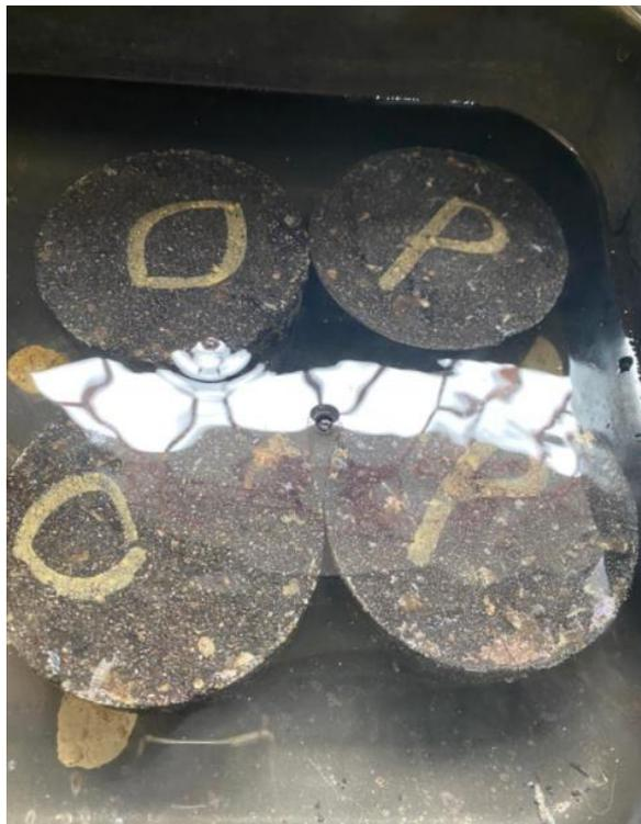
Figura 22: Briquetas en Baño María, a 60 grados, durante 24 horas
