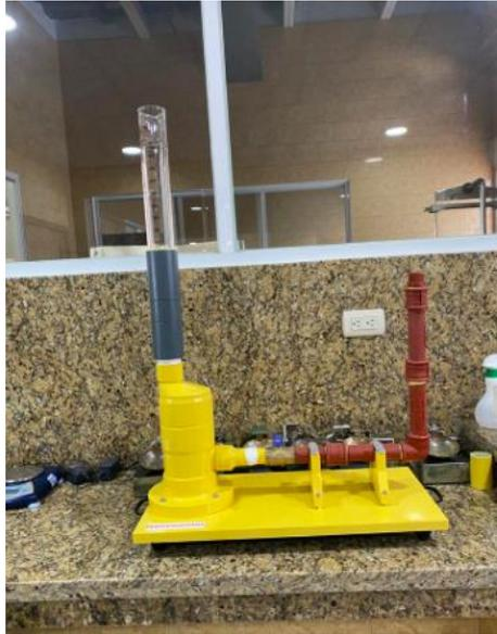
**Figura 23: Permeámetro de carga variable**
