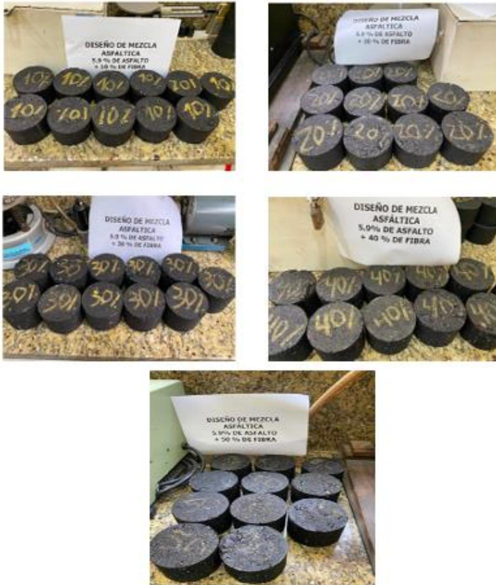
Figura 21: Briquetas con diferentes porcentajes de adición de fibra metálica - (10%, 20%, 30%, 40% y 50%)
