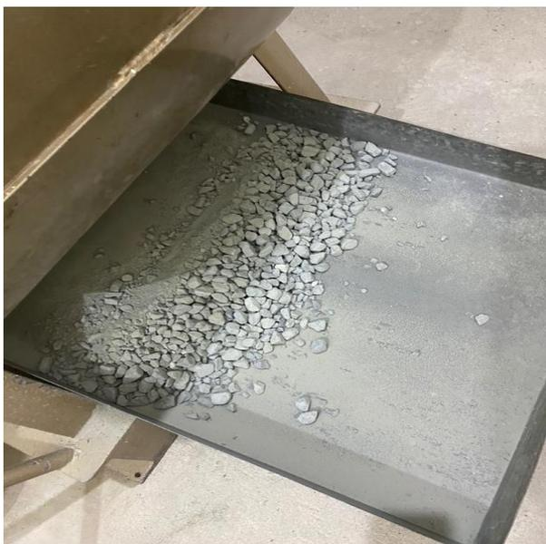
**Figura 14: Muestra #3 - Cisco luego de ensayo de Abrasión de los Ángeles**
