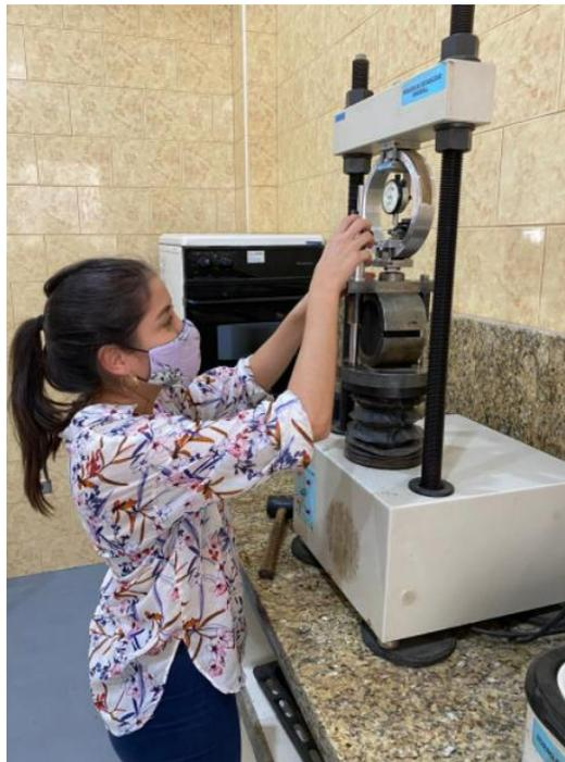
**Figura 20: Rotura de briquetas asfálticas**
