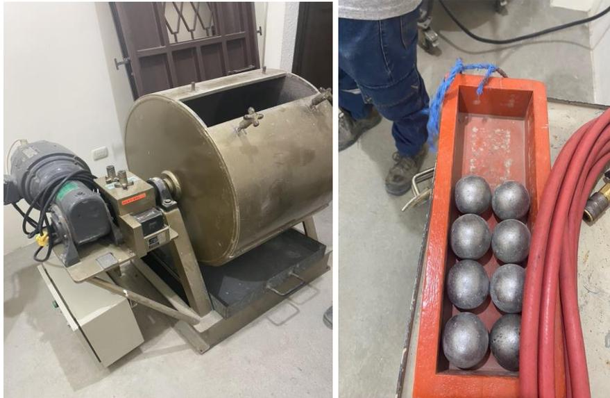
**Figura 12: Máquina de Abrasión de los Ángeles - Esferas de acero**
