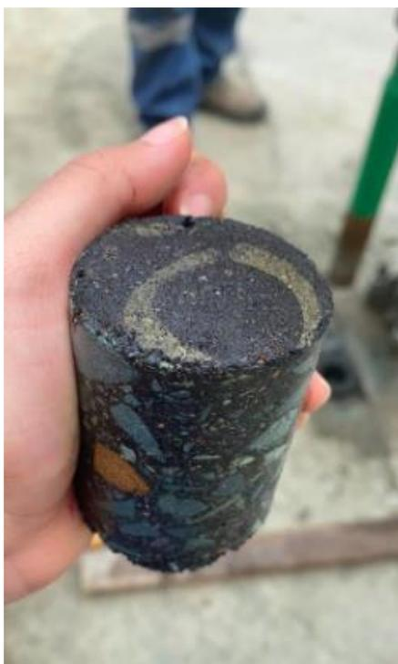
**Figura 24: Núcleo de 4.8cm para ensayo de Permeabilidad**
