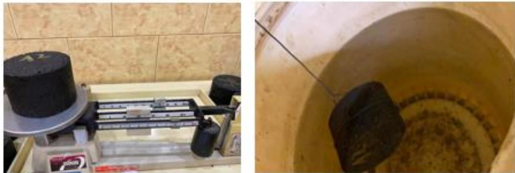
**Figura 18: Gravedad Especifica BULK**
