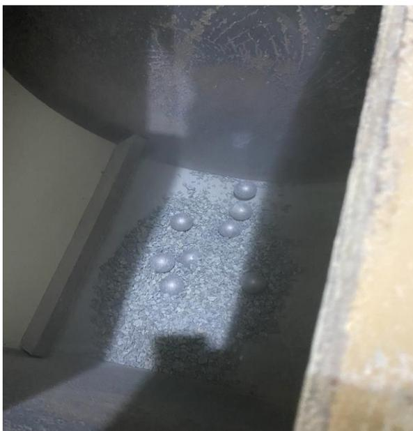
**Figura 13: Muestra#1 - Piedra – Cargas abrasivas según el Método “B” de la norma ASTM C131**
