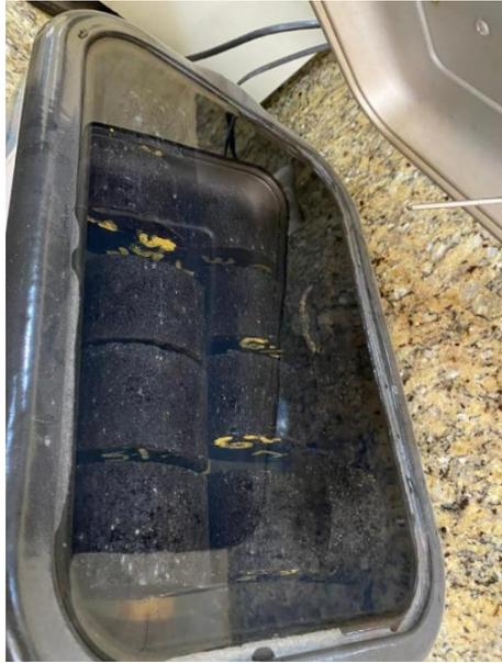
**Figura 19: Baño María realizado a las briquetas asfálticas antes de la rotura**
