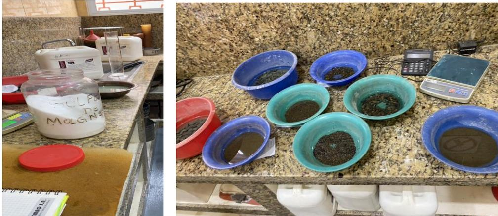
Figura 15: Colocación del sulfato de Magnesio durante 5 ciclos
