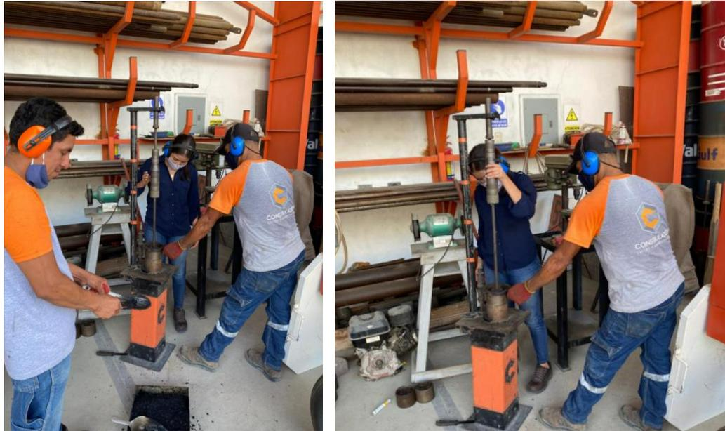
**Figura 9: Martillo para elaboración de briquetas**
