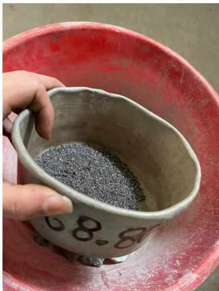
**Figura 7: Fibra metálica reciclada, "viruta"**
