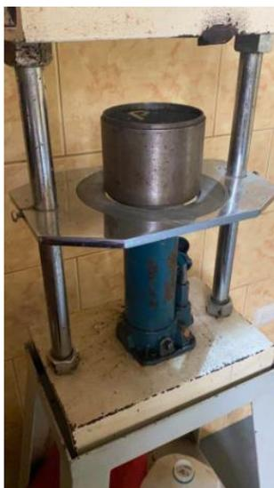
**Figura 11: Gato hidráulico utilizado para desencofrar briquetas asfálticas**
