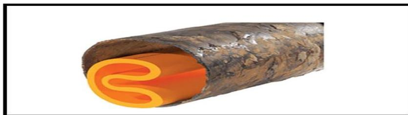
**Figura 13 Forma en la cual va colocada la tubería de polietileno doblada longitudinalmente en forma de C durante el proceso de extrusión**
