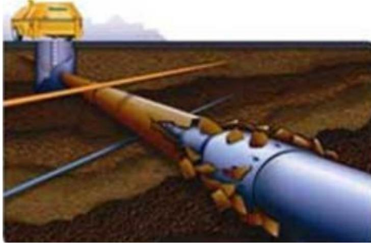
**Figura 6 Explicación del uso del método de fractura de tubería, visto en una tubería instalada en el suelo.**
