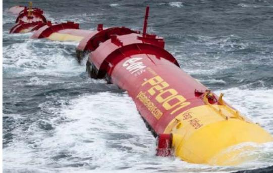
Figura 1.5. Ingenio Pelamis, capaz de generar 1MW a partir de la energía de las olas.
