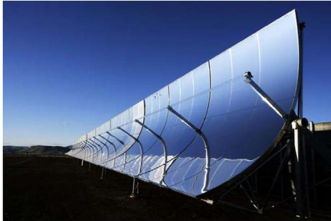
Figura 1.2. Estaciones solares térmicas. Se muestran colectores del tipo de concentradores distribuidos
