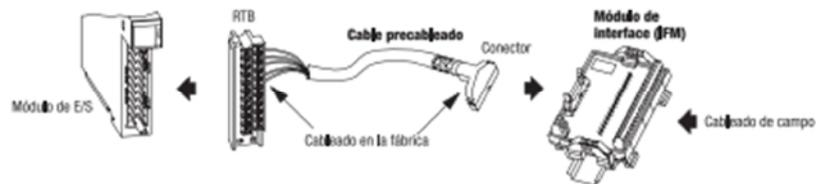
Fig. 2.12: Conexión de señales de campo a E/S Controllogix
