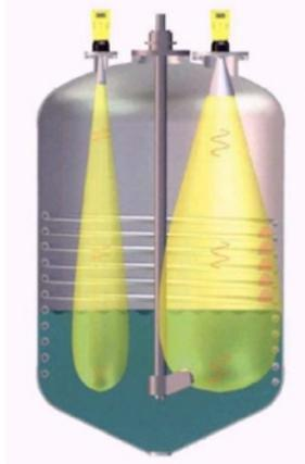
**Fig. 2.16: Transmisor de nivel por radar.**
