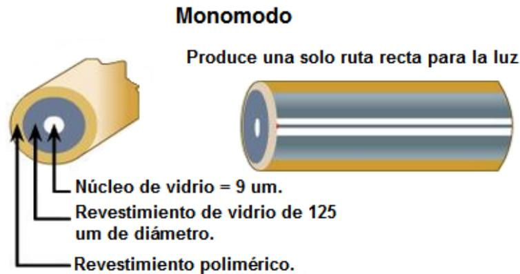
Figura 2. 9: Fibra Óptica Monomodo (SM).
