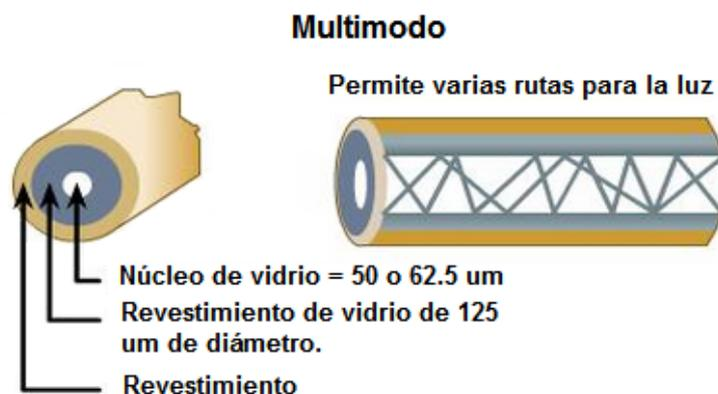
Figura 2. 8: Fibra Óptica Multimodal (MM).
