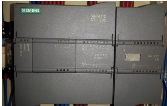
Figura 4.1 Selección Equipos PLC
