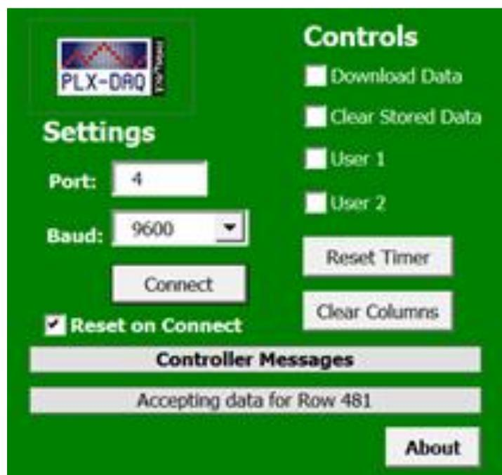
Figura 3.7 Configuración del puerto y la velocidad del PLX DAQ
