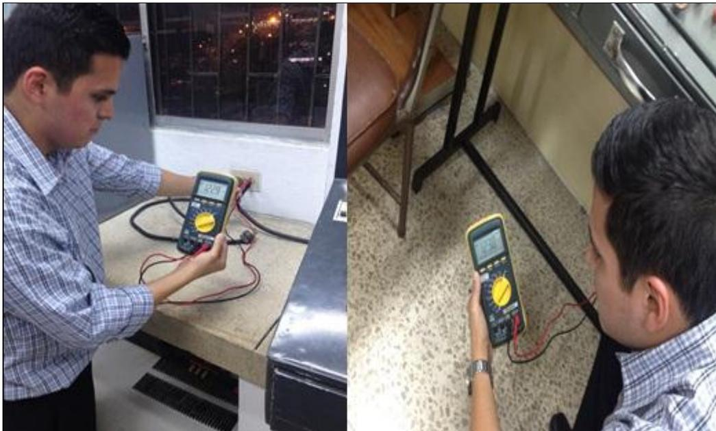
Figura 4.3. Medición de voltaje en tomacorrientes
