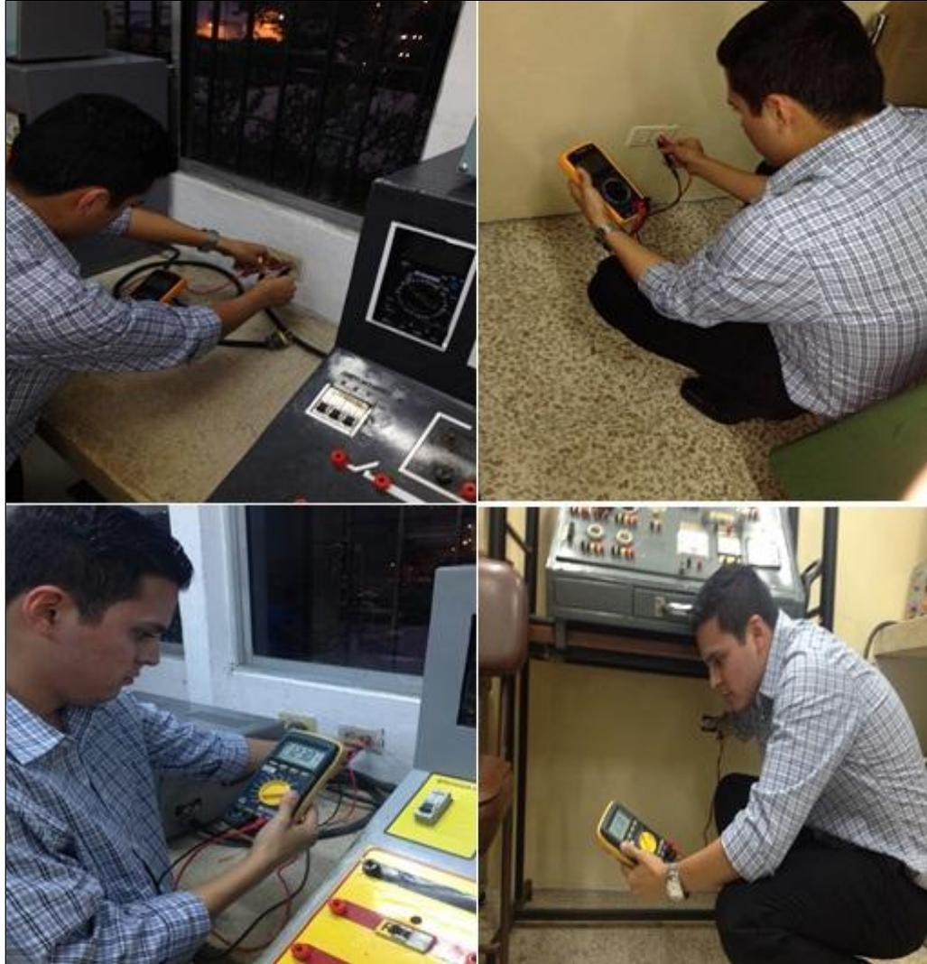
Figura 4.2 Medición de tierra y voltaje en tomacorrientes del laboratorio
