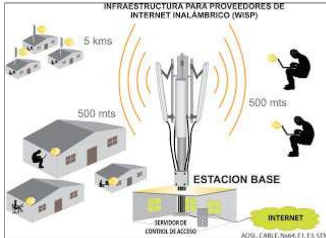
**Figura 2.4 Esquema de funcionamiento de un ISP**
