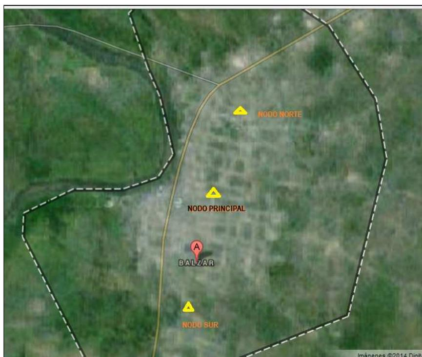
**Figura 2.7 Determinación de ubicación de nodos del WISP en Balzar, plano con Google Earth**
