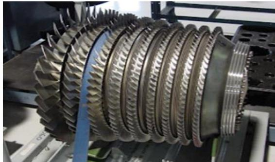
Figura 2. 9 Compresor axial
