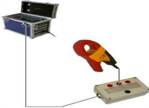
Figura 3. 6 conexión de la pinza amperimétrica
