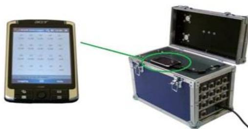
Figura 3. 5 Caja de medición data Logger BOGE
