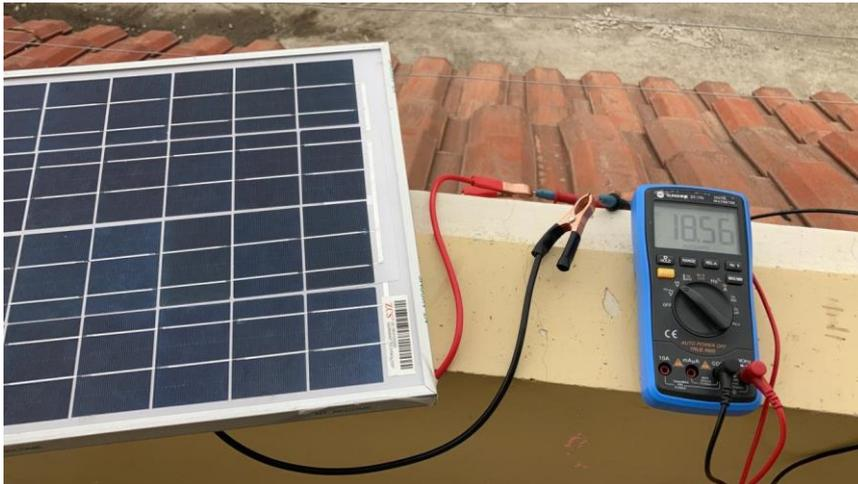
Figura 4.6: Prueba de voltaje máximo del panel solar
