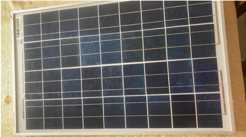
Figura 4.4: Panel solar del aireador
